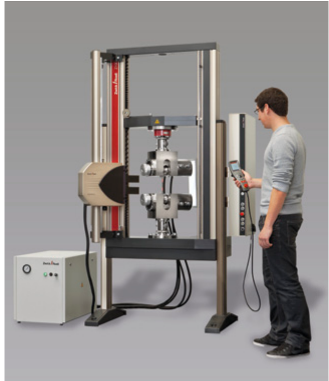
Anwendung mit optischem Längenänderungsaufnehmer
