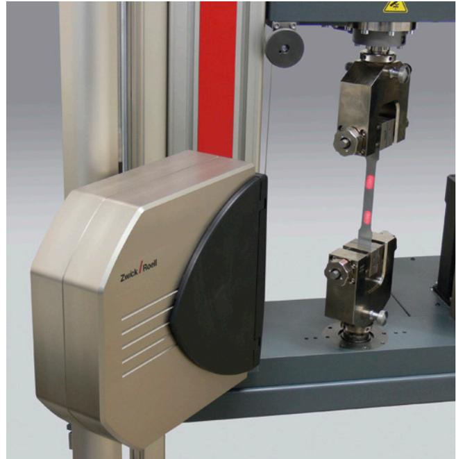
Bild 2: Der laserXtens mit dem typischen Speckle-Muster
