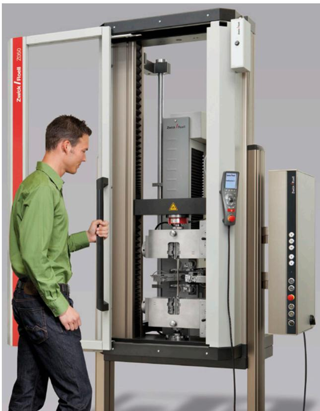
Bild 1: Der universale Längenänderungsaufnehmer multiXtens
