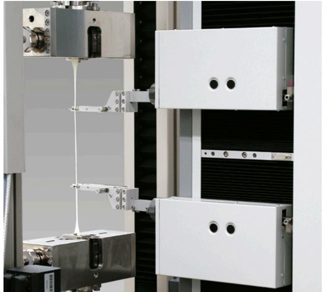
Bild 2: Die Messköpfe sind auf den Messschlitten angebracht. An ihnen werden die leicht auswechselbaren Messfühler befestigt
