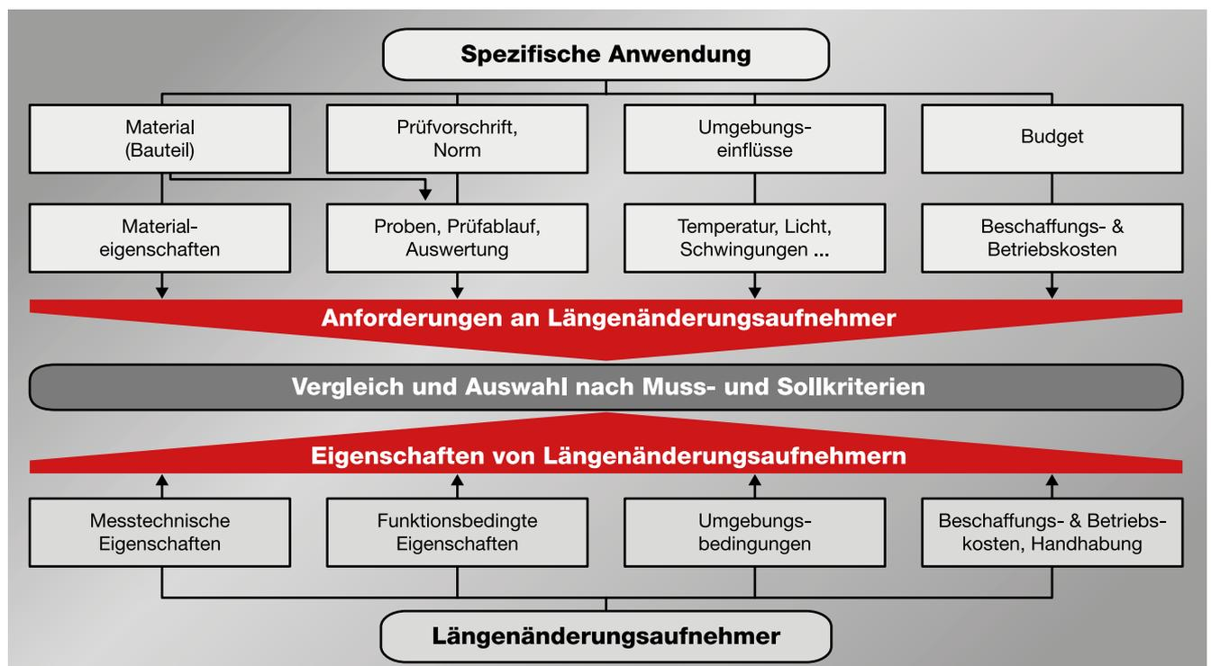
Auswahlschema für den geeigneten Längenänderungsaufnehmer
