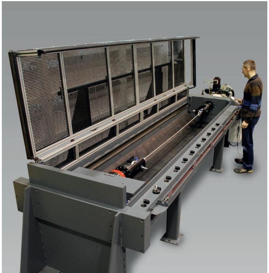
Bild 1: Horizontale servohydraulische Prüfmaschine für zyklische Drahtseilprüfung
