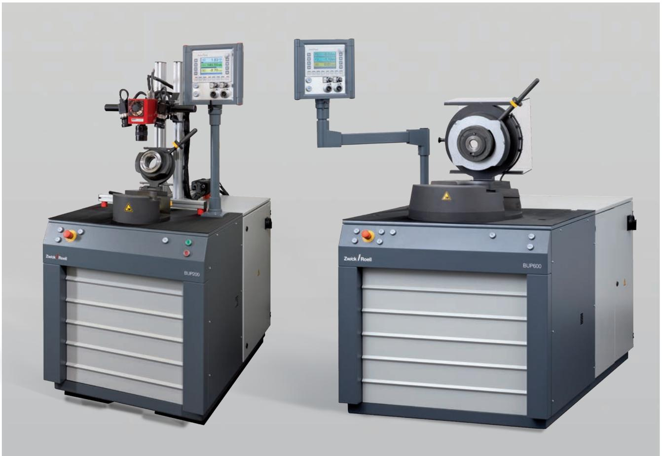
Bild 1: Blechumform-Prüfmaschinen von 100 kN bis 1.000 kN der BUP Serie. Optional mit optischen Messsystemen
