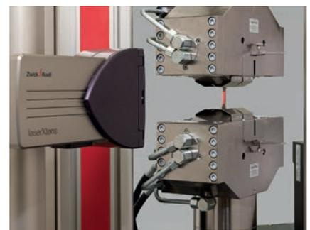
Bild 6: laserXtens Compact für kurze Proben
