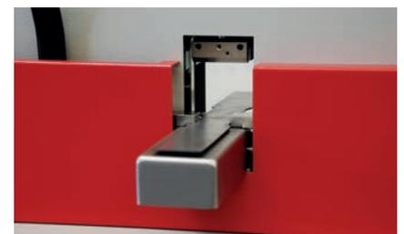
Bild 5: Querschnittsmessung an einer Flachprobe
