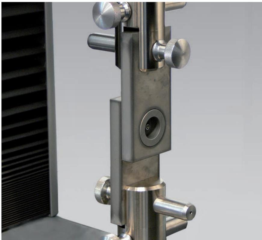
Bild 1: Scherversuch an Nietverbindung
