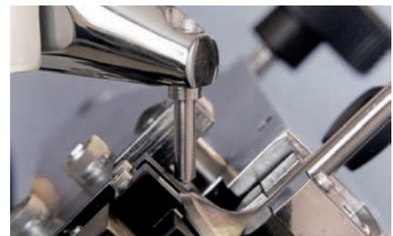
Bild 3: Rockwellprüfung an wärmefließgepressten Motorventilen
