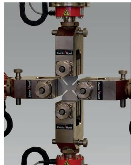
Bild 2: Biaxialer Zugversuch
