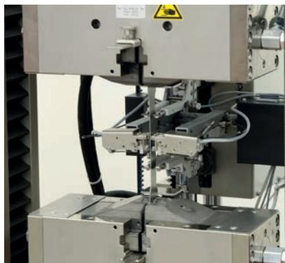
Bild 1: makroXtens und Variante mit optionaler Feindehnungsmessung (unten)
