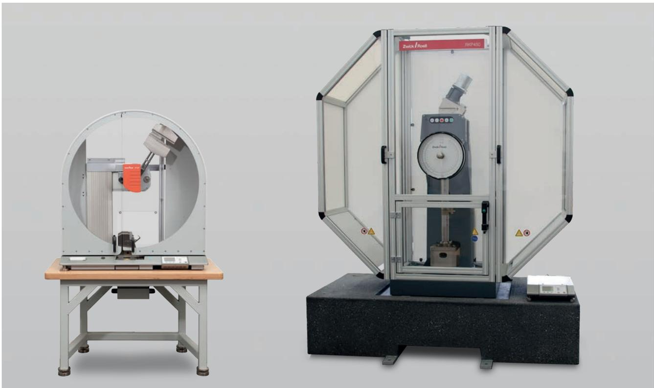
Bild 1: Pendelschlagwerke für Charpy- und Izod-Versuche, HIT 50P und RKP 450
