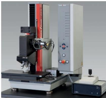
Bild 1: Universelle Härteprüfmaschine ZHV30/zwickiLine
