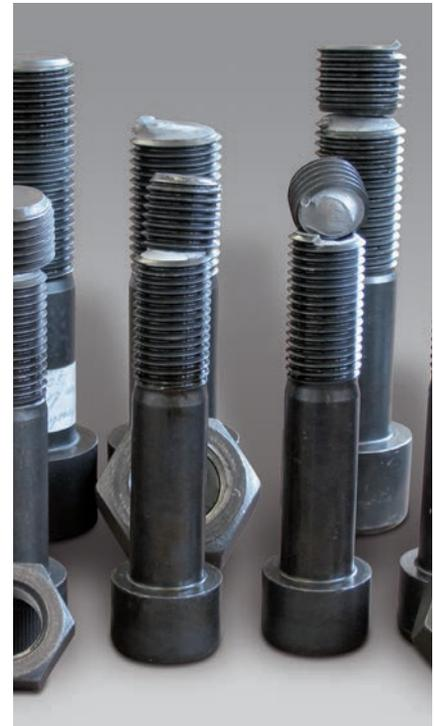
Bild 3: Schrauben nach Prüfung
