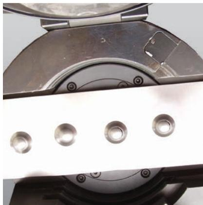
Bild 3: Versuchsergebnis nach Erichsen-Test
