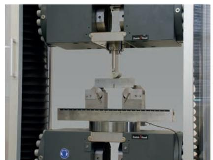
Bild 4: Hydraulische Großlast-Probenhalter für Prüfanwendungen bis 2.500 kN
