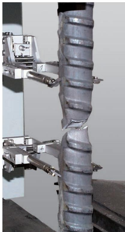
Bild 1: Zugversuch an Betonrippenstahl mit Längenänderungsaufnehmer makroXtens
