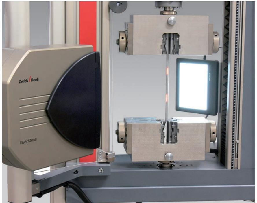
Bild 1: Längenänderungsaufnehmer laserXtens mit Option videoXtens für Breitenänderung
