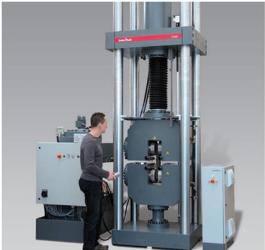
Bild 2: Großlast-Prüfmaschine mit beidseitig schließenden hydraulischen Probenhaltern
