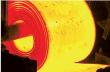
Unter Bändern versteht man Stahl und Nichteisenmetallerzeugnisse, die zu Bündeln (Coils) aufgerollt sind; wie das Warmband, welches als Vormaterial für kaltgewalzte Bleche dient.
