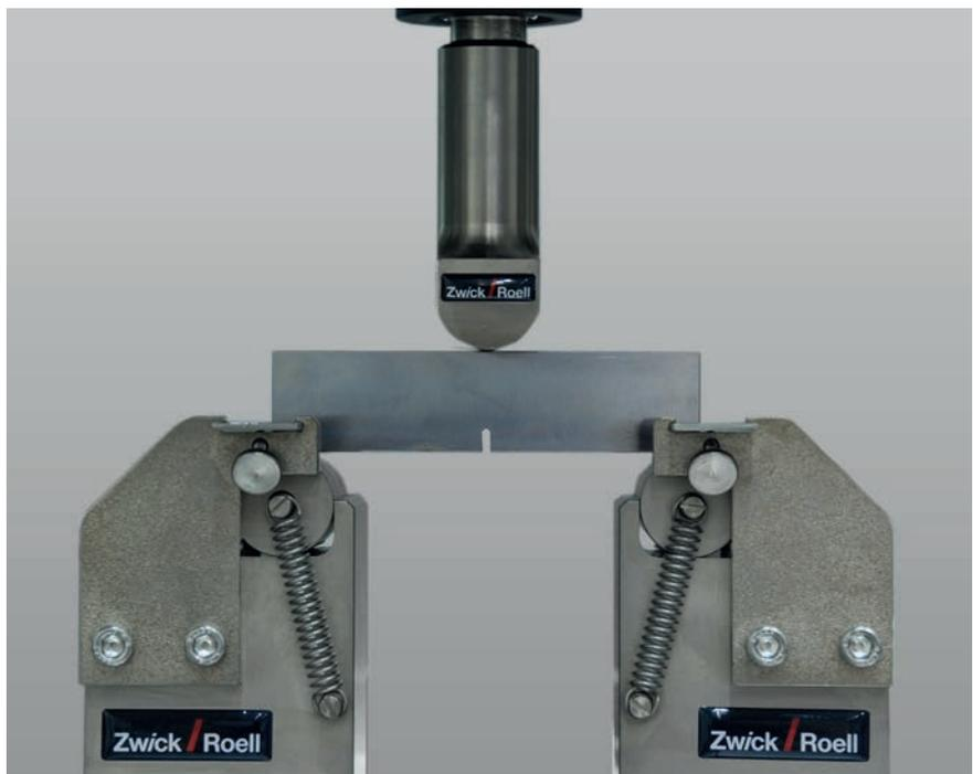
Bild 2: SENB Probe in Hochfrequenzpulsator Vibrophore
