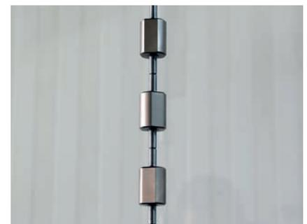
Bild 3: Überprüfung der Wasserstoffversprödung nach ASTM F 519
