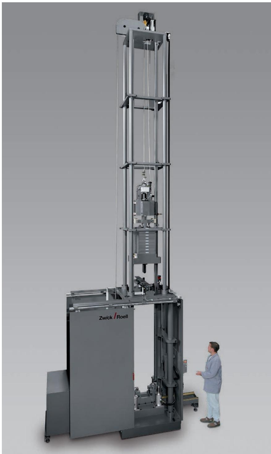
Bild 2: Groß-Fallwerk DWT 40 (Fallhöhe 5 m)
