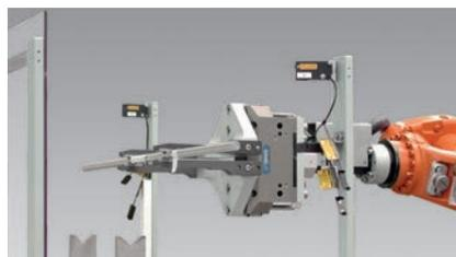
Bild 5: Automatische Längenmessung
