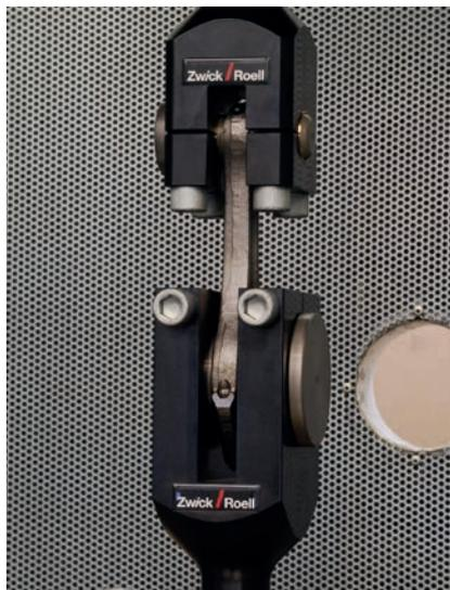
Bild 2: Ermüdungsprüfung an Pleuel
