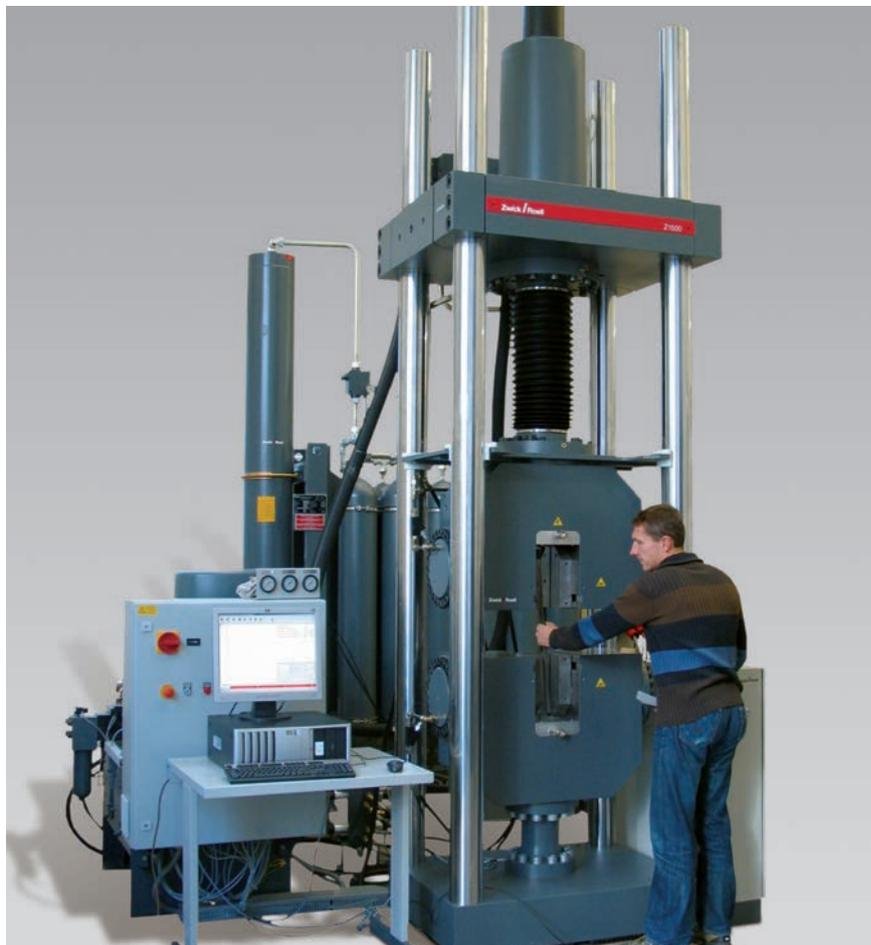
Bild 1: Großlast-Prüfmaschine für Erdbebenversuche nach Norm
