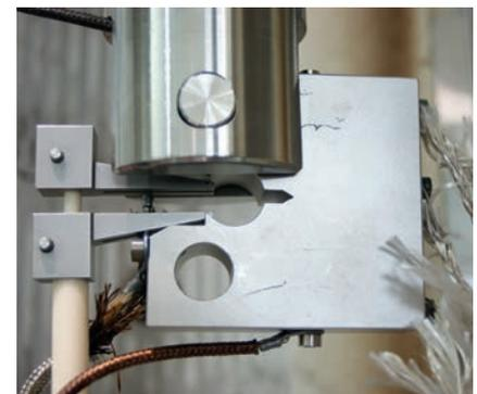
Bild 2: Rissaufweitungs- und Rissfortschrittsmessung nach ASTM E 1457
