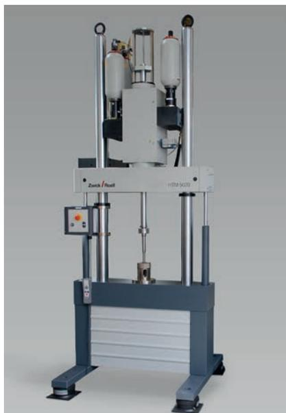
Bild 1: Hochgeschwindigkeits-Prüfmaschine
