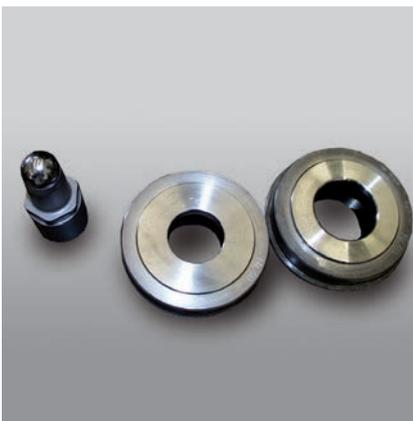
Bild 1: Tiefungswerkzeug für Erichsen-Test
