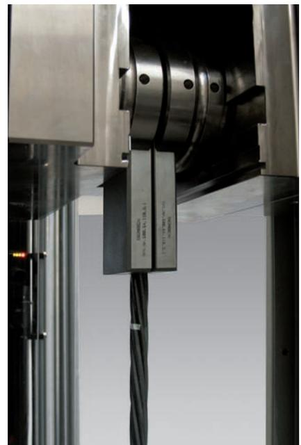
Bild 2: Klemmvorrichtung für Spannlitzen
