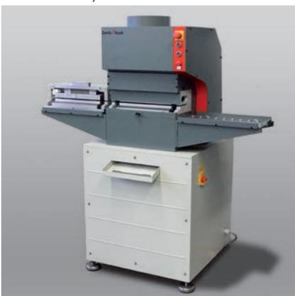
Bild 1: Probenstanze M-Cut 65
