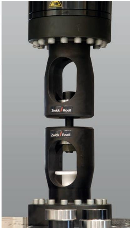
Bild 1: Ermüdungsprüfung an Schrauben
