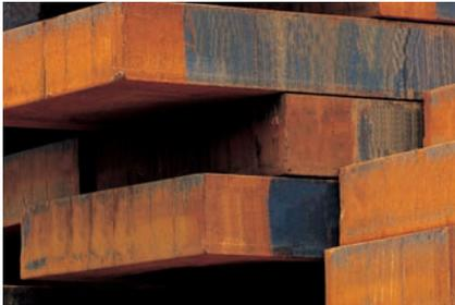
Grobbleche sind Stahlbleche mit einer Breite von bis zu vier Metern und einer Dicke von mindestens fünf Millimetern bis ca. 250 mm. Sie finden hauptsächlich Verwendung am Bau, für schweres Gerät und Krane, im Schiffsbau, bei off-shore Bohrplattformen und für Rohre mit großen Durchmessern und Wandstärken.
