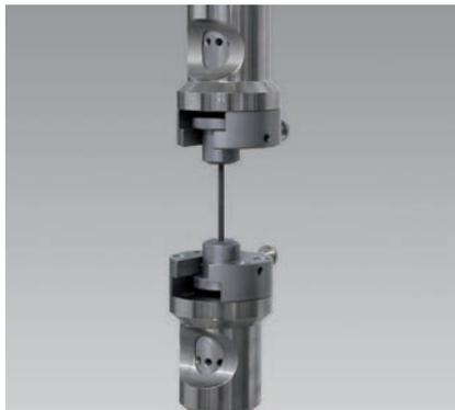
Bild 1: Zugversuch an Rundprobe
