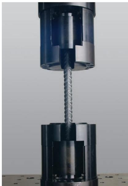
Bild 2: Probenhalter und Probenverguss für Betonrippenstahl
