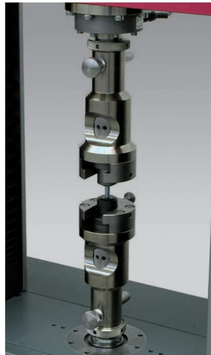
Bild 2: Zugversuch an Schrauben
