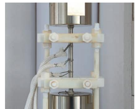
Bild 4: Probe für den Zeitstand-Zugversuch (Extensometer und Thermoelemente).
