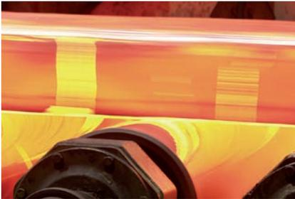
Stangen und Stäbe sind rund oder kantig geformte Langprodukte mit Querschnitten von bis zu 240 x 320 mm<sup>2</sup>, die im Walz- und Schmiedebereich vielfältige Anwendungen finden: als Ausgangsprodukt für Walzdrähte und Profile ebenso wie für Schmiedeteile in der Fahrzeugindustrie wie Pleuel, Kurbelwellen und Eisenbahnschienen oder auch Generator- und Turbinenwellen in der Energietechnik; als Endprodukte beim Brückenbau und Schiffsbau ebenso wie im Apparate- und Behälterbau.
