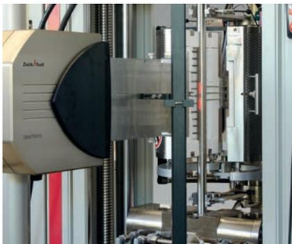
Bild 1: Hochtemperatur-Ofen mit laserXtens
