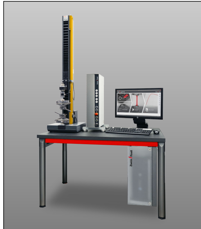
zwicki 1120 nach der Modernisierung mit testControl II
