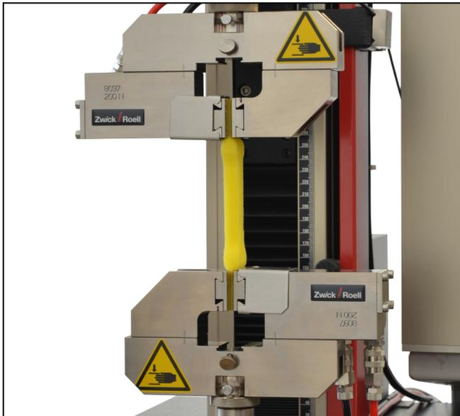
Pneumatik-Probenhalter Typ 8097 Fmax 200 N, Gegenbacke gestuft verstellbar
