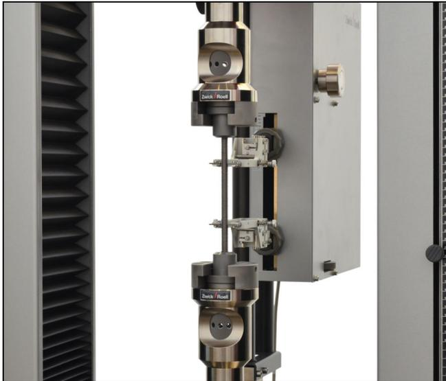
Probenhalter für Schulter-, Schrauben- und Gewindekopfproben Typ 8496, Fmax 50 kN
