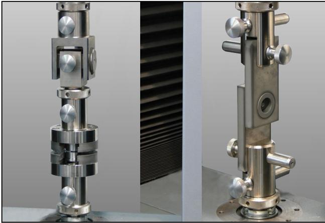
Zugversuch (links), Scherversuch (rechts)
