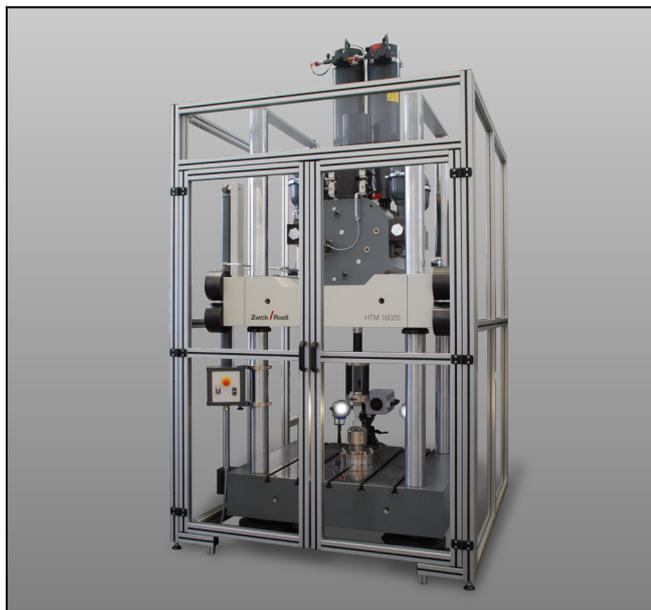
Hochgeschwindigkeits-Prüfmaschine HTM 16020
