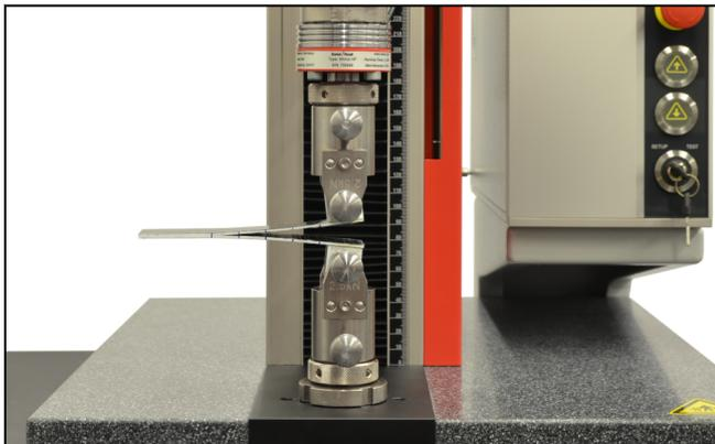
Vorrichtung zur  $G_{IC}$ -Prüfung an langfaserverstärkten Verbundwerkstoffen
