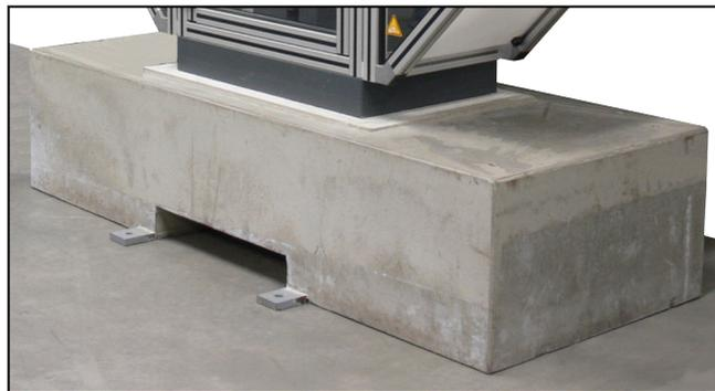
Pendelschlagwerk mit Betonsockel
