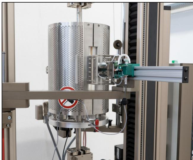
Kontaktierendes Hochtemperatur-Extensometer bis 1.200°C
