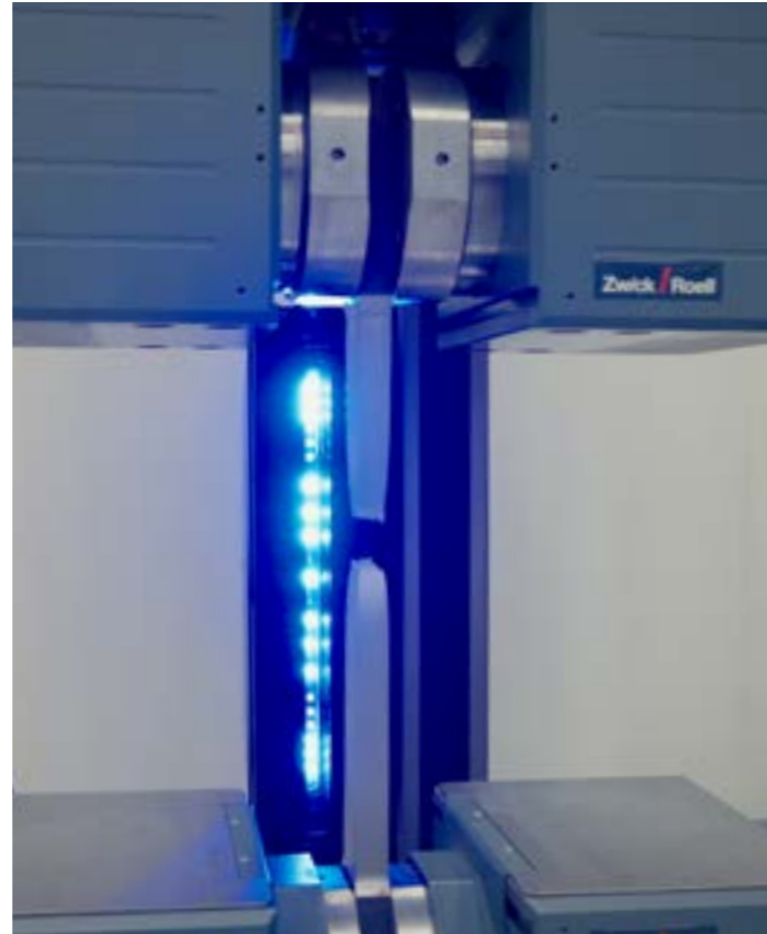
使用光学应变测量装置进行拉伸试验
