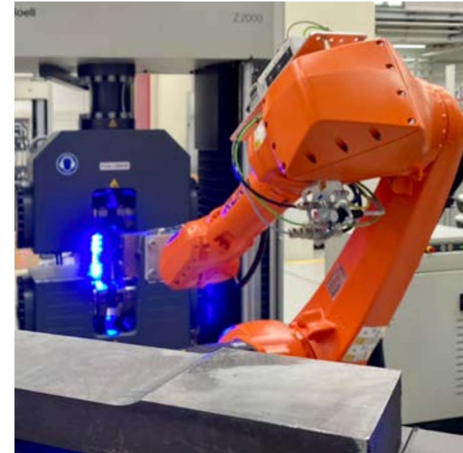
使用机电式大载荷试验机 Z2000E 进行钢筋自动拉伸试验
