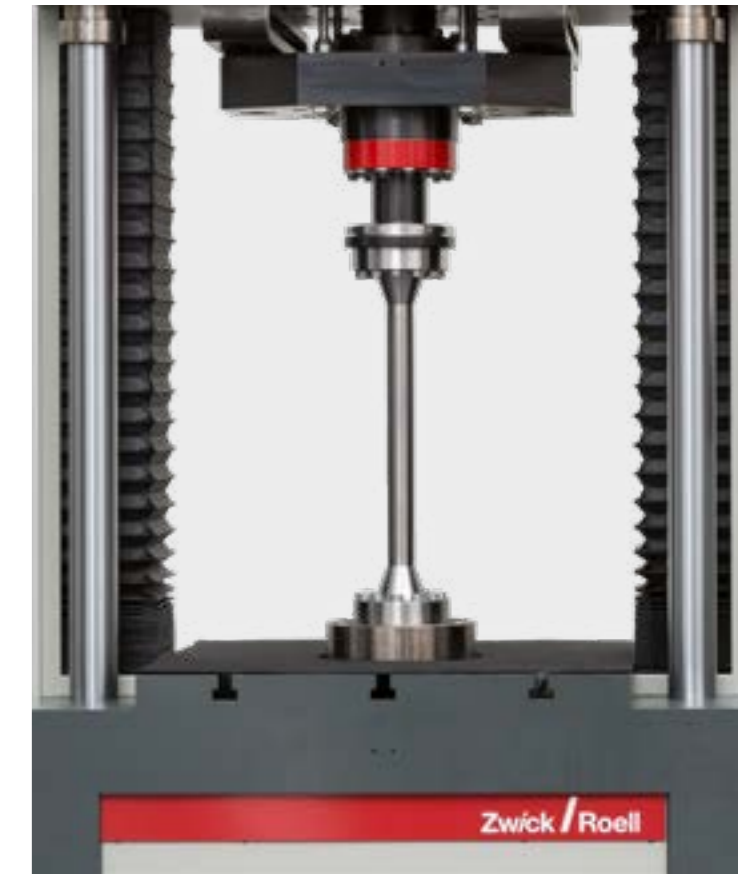
用于循环试验的高频振动器 Vibrophore 250
