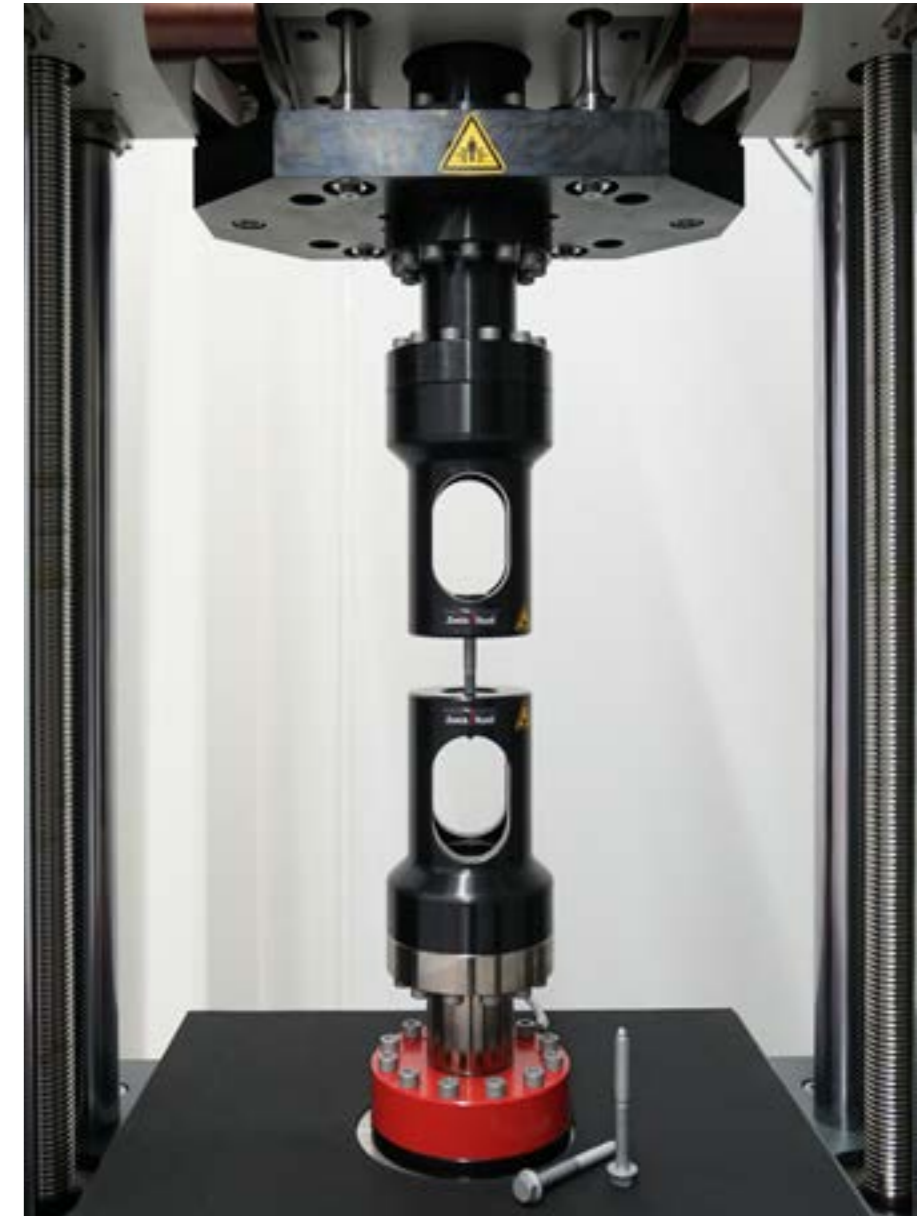
使用合适的试样安装件进行螺钉拉伸试验
