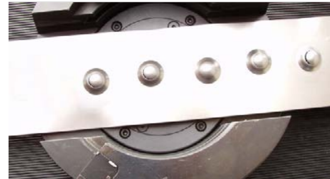
使用 BUP 金属薄板试验机执行埃里克森试验
