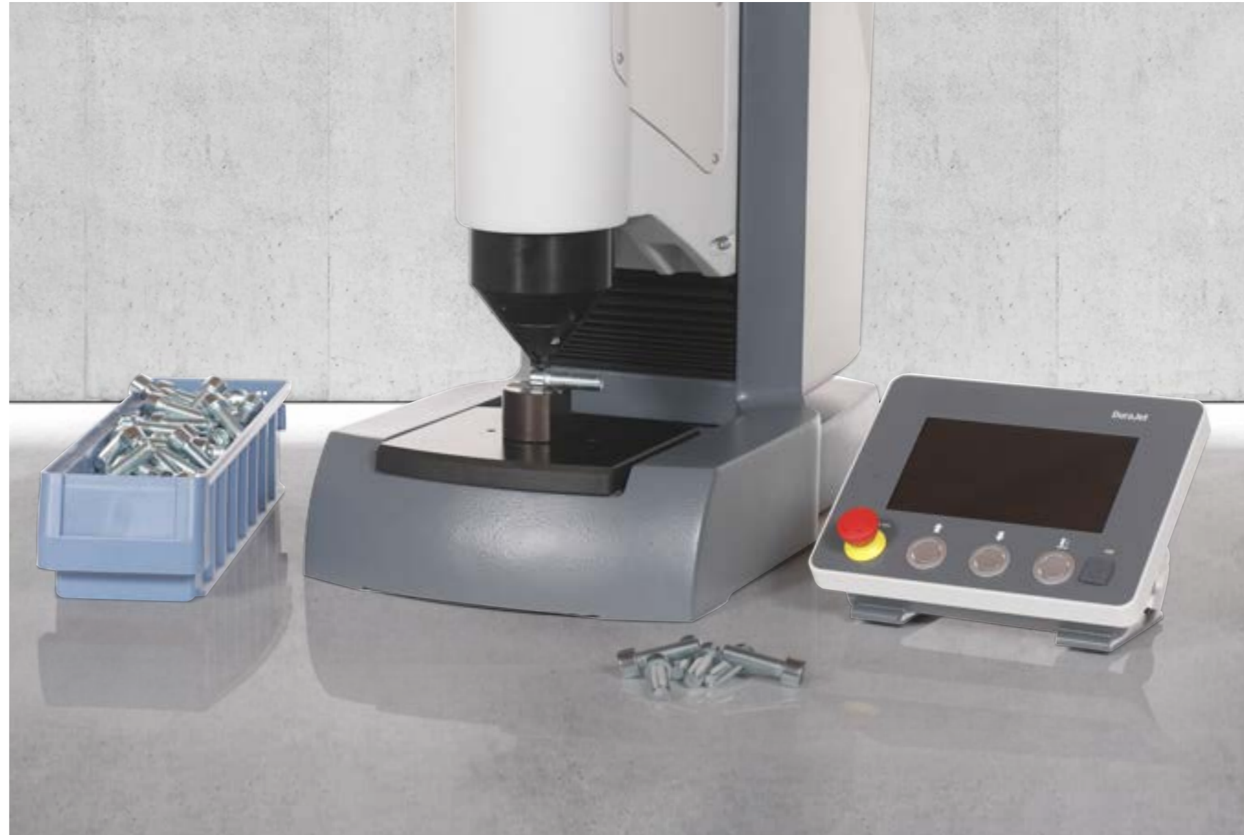
对螺钉进行洛氏硬度试验
