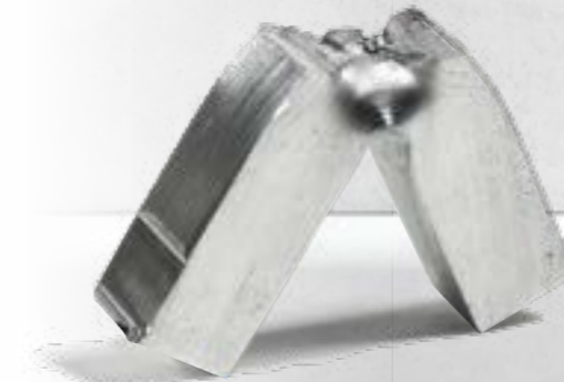
测试后的简支梁试样
