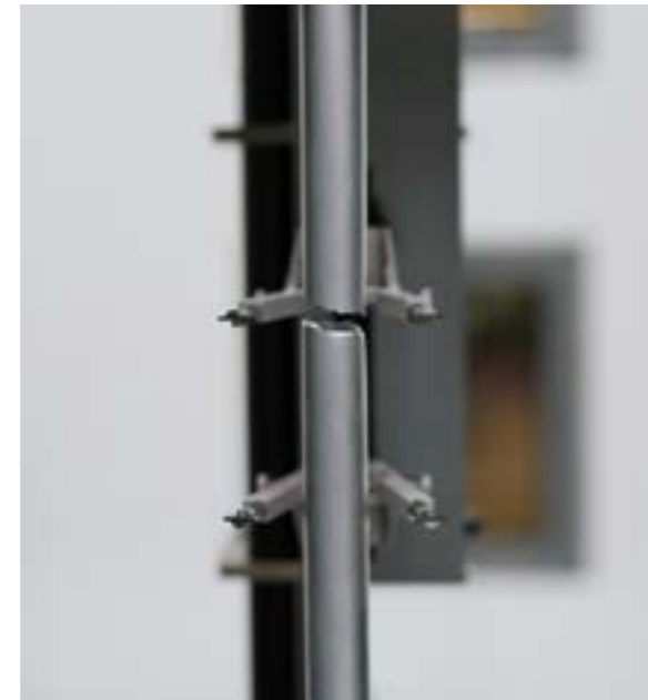
管材部件拉伸试验
