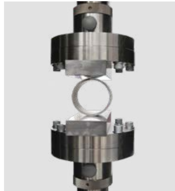
管道压缩试验
