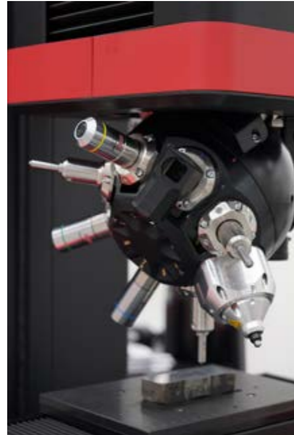
使用 VisionLine 进行厚板硬度试验
