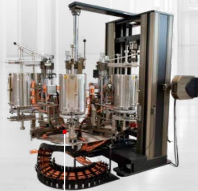
带熔炉转塔的高温试验系统
