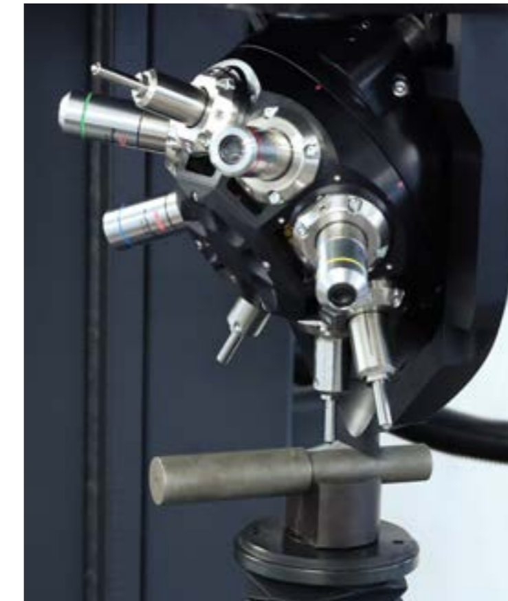
使用圆柱形固定件进行圆棒材料硬度试验
