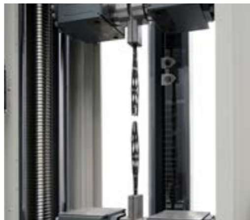
拉伸试验 - 钢绞线试验(断裂后)
