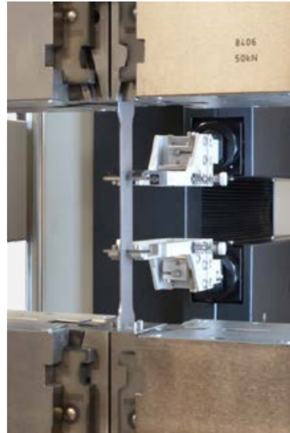
在拉伸试验中测定 r 值和 n 值
