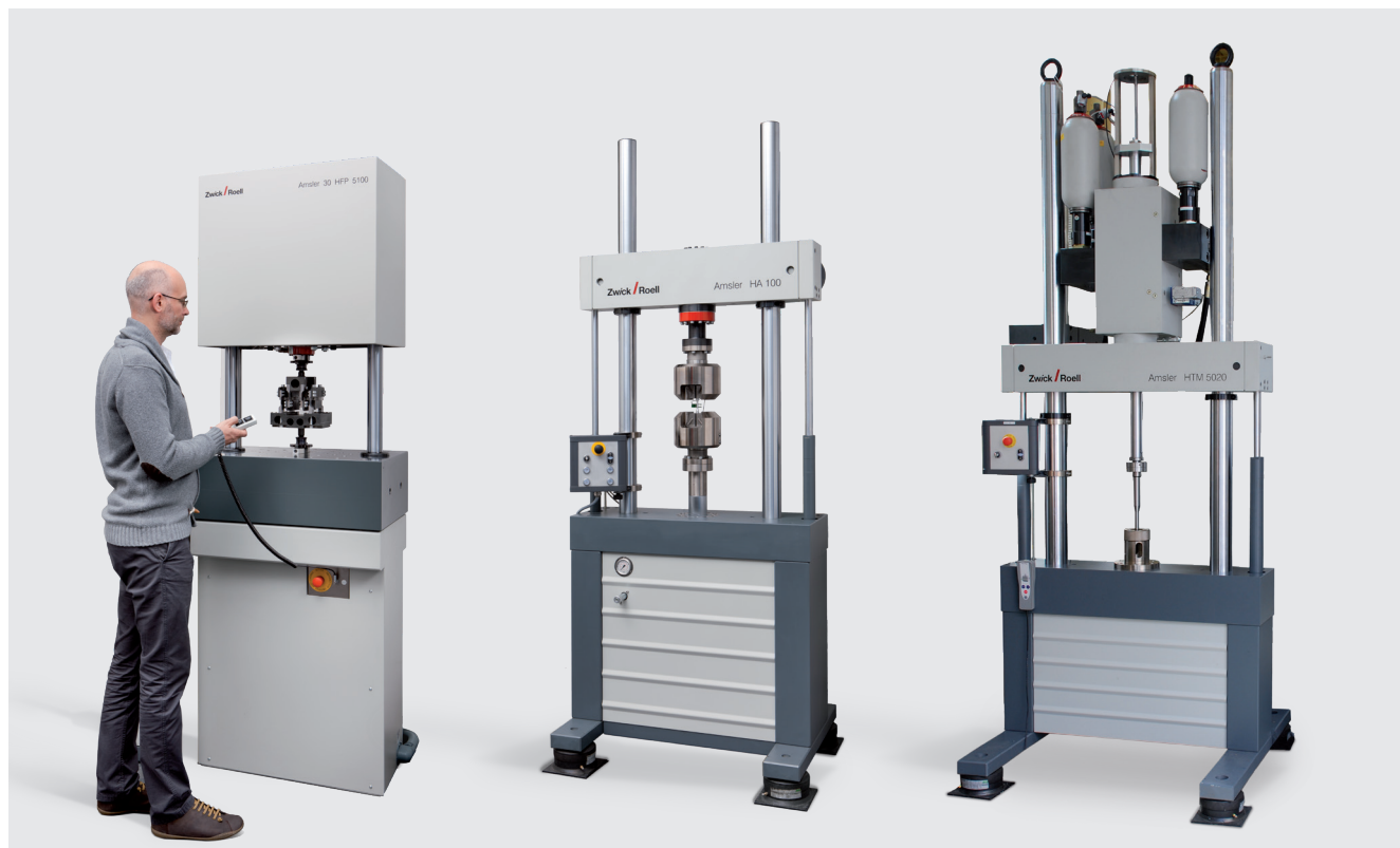
图 1: ZwickRoell Vibrophore高频疲劳试验机用于高频率(高达300 Hz)的共振测试,经典的HA 100电液伺服疲劳试验机,HTM 5020高速试验机(50 kN和20 m/s)
