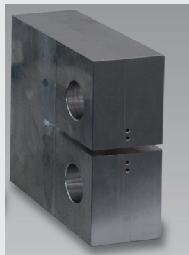
图 3: CT试样、预裂试样及使用testXpert Research观测断裂行程
