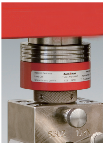
图 1:Xforce系列的力传感器采用多梁式结构
