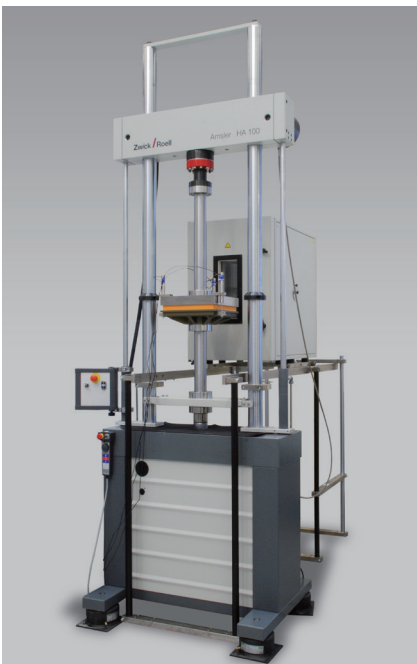
图 1: 配备高温炉的电液伺服疲劳试验机
