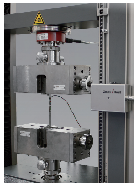
图 5:应变片通过预配置的串联开关盒直接连接至testControl II
