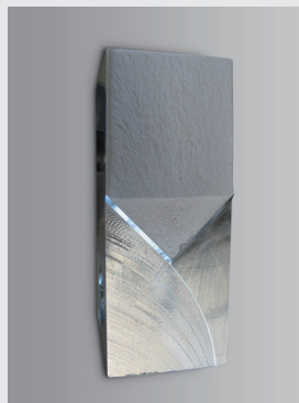
图 4: 断裂试样, 显示力值、裂纹长度、 R+a/W 、应力强度、裂纹扩展及每dK裂纹扩展
