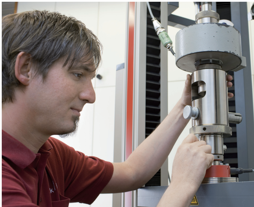
图 2:每台力传感器在安装于试验机投入使用时,均由ZwickRoell进行校准。
