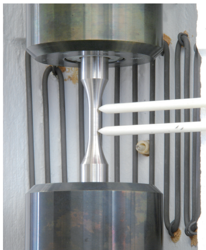
图 1: 高温下带引伸计的LCF测试
