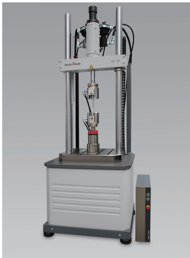
图 1: HC 25电液伺服疲劳试验机, 配备混凝土基座
