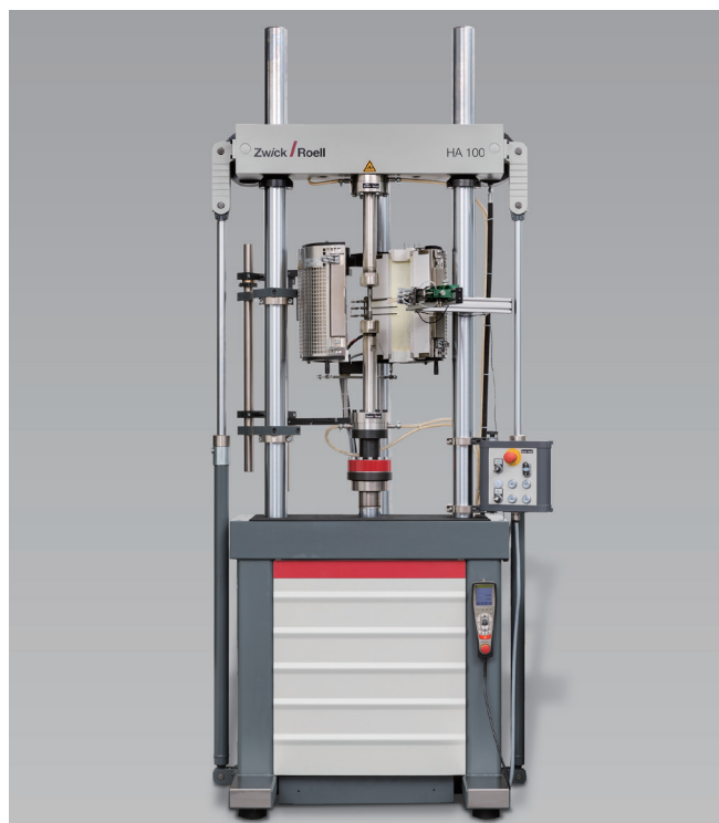
图 1: HA 100用于高温(最高至1200°C)的低周疲劳(LCF)试验
