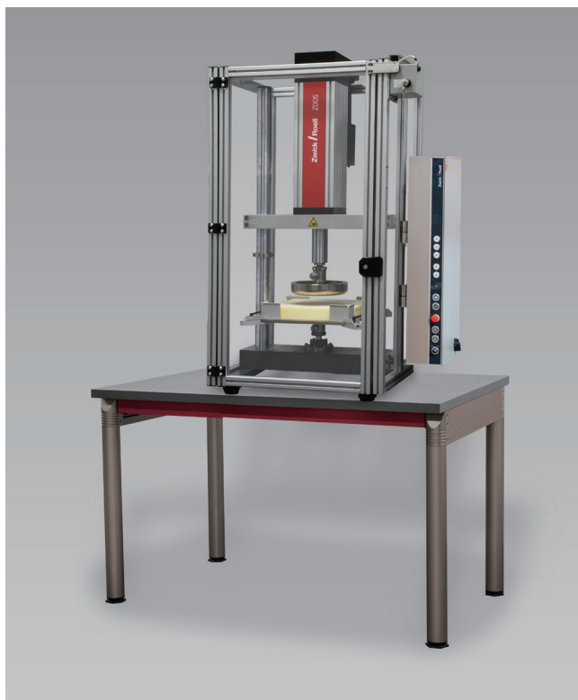
图 1: 电子-机械伺服试验作动缸对泡沫材料进行疲劳试验
