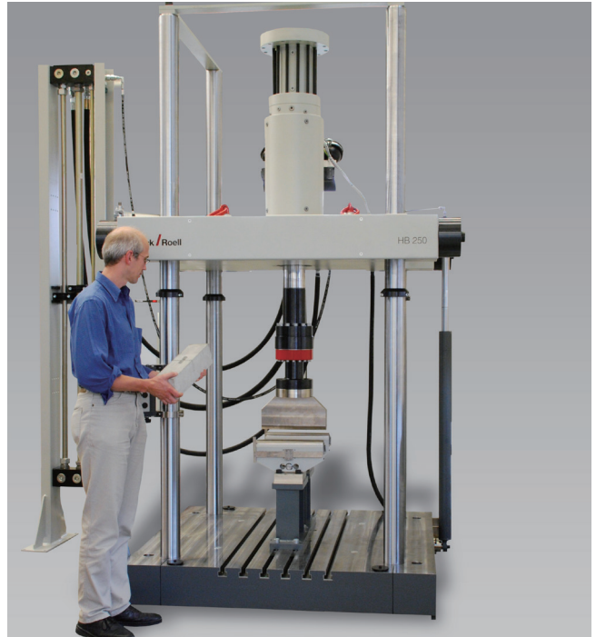
图 2: 四立柱HB250, 用于材料和部件试验
