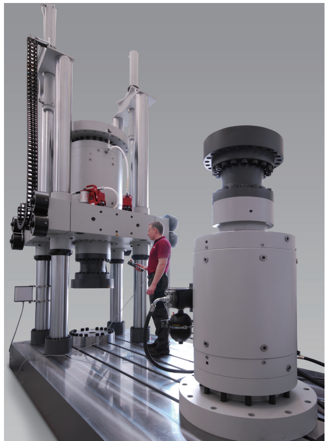
图 3: 电液伺服门框式试验台, 用于飞机部件试验
