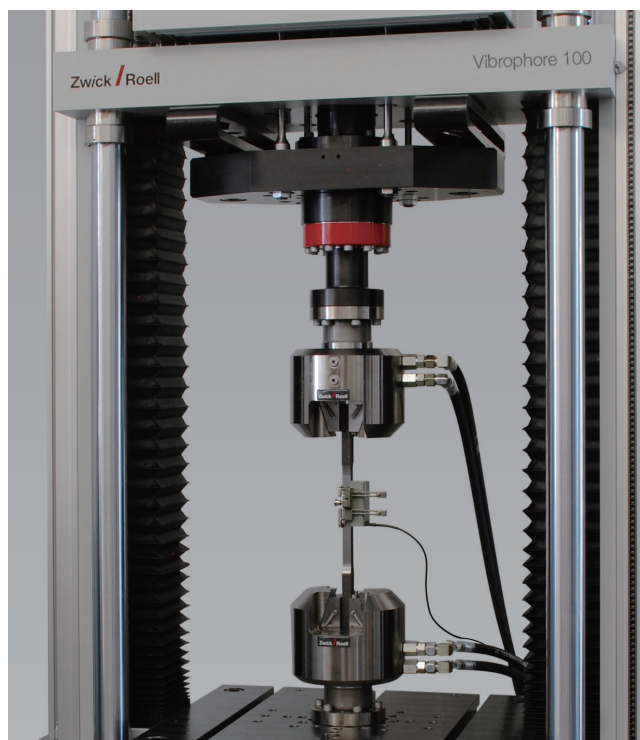
图 2: 集成makroXtens引伸计(上图)和夹持式引伸计(下图)，用于静态拉伸试验
