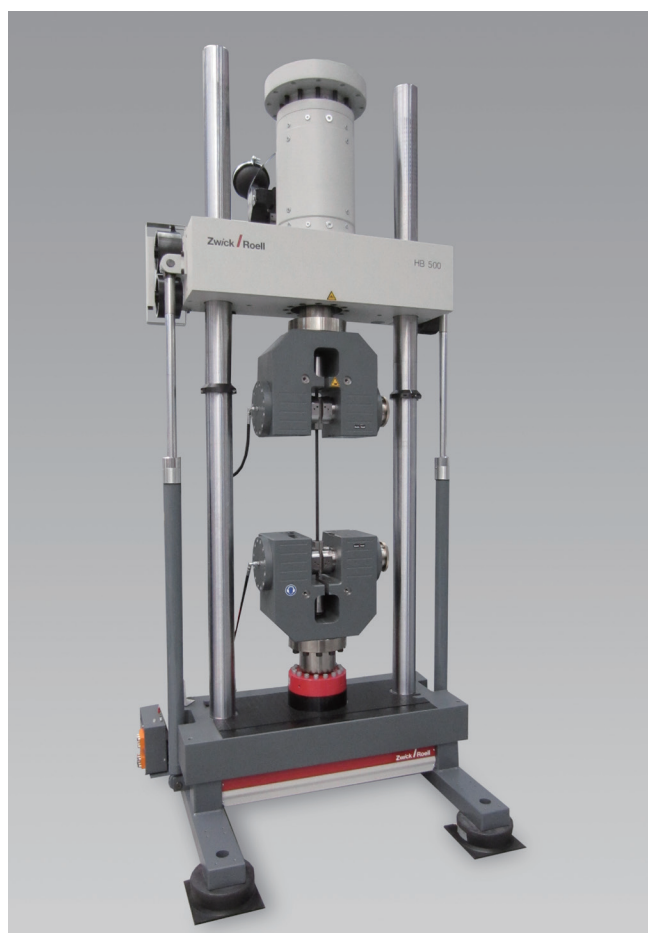
图 2: 纹线的高周疲劳试验, 符合ISO 15630-3标准
