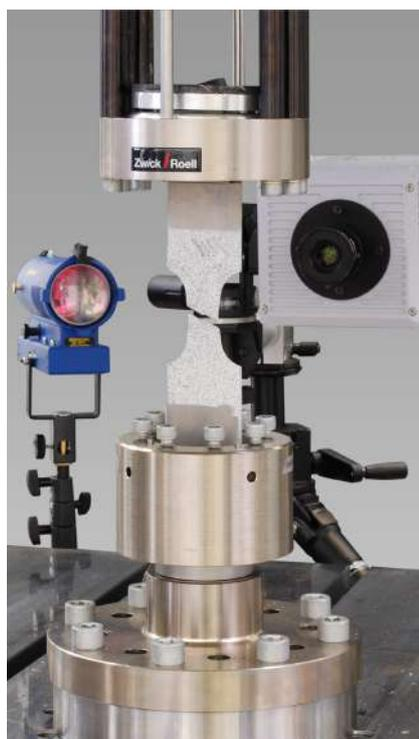
图 2: 试验速度高达 20 m/s 的高速拉伸试验
