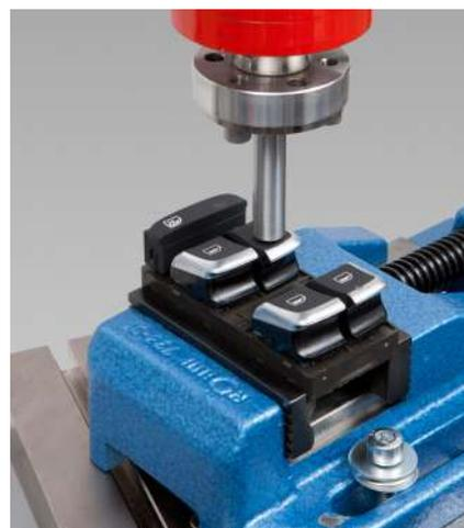
图 2: 车窗升降开关元件功能试验
