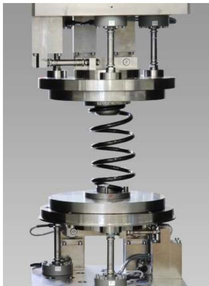
图 1: 多分量避震弹簧试验
