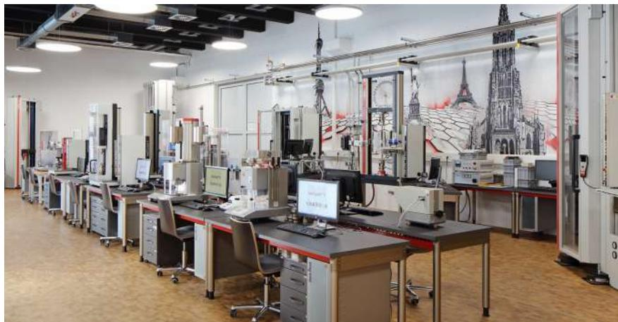
图 1: ZwickRoell 测试实验室中的静态试验机和试验仪器
