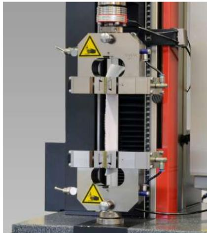
图 2: 安全气囊织物试验
