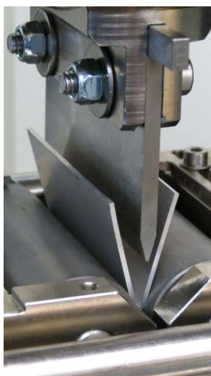
图 3: 符合 VDA 238-100 标准的板弯曲试验
