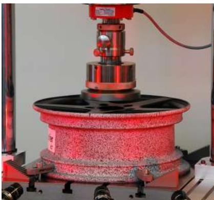
图 4: 测量 CFRP 轮辋的全表面变形
