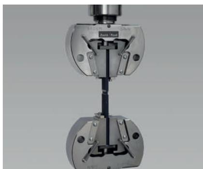
图 2: 用于粘合两种纤维复合材料的开槽试样剪切试验
