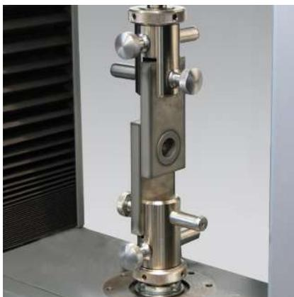
图 3: 铆接接头剪切试验
