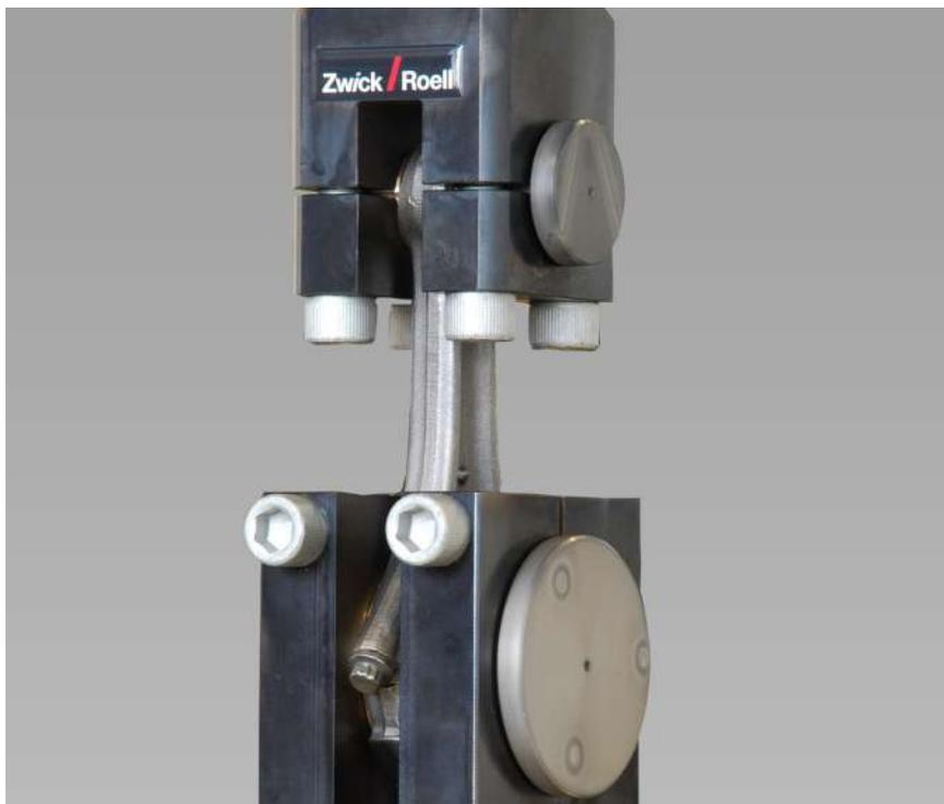
图 1: 连接杆疲劳试验
