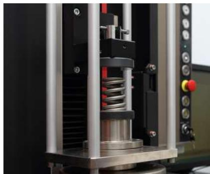
图 4: 气门弹簧试验
