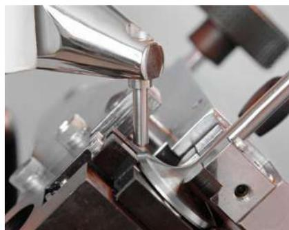
图 5: 气门硬度试验
