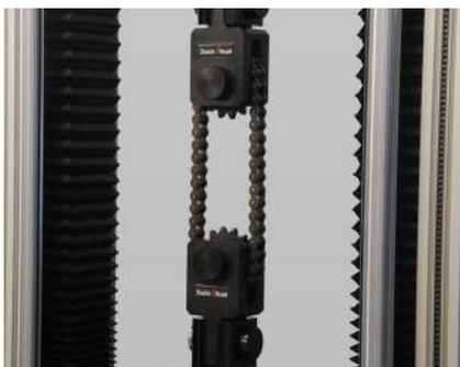
图 2: 发动机链条疲劳试验
