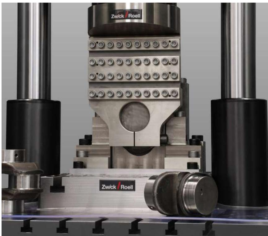
图 2: 采用 Vibrophore 对曲轴部件施加动态载荷
