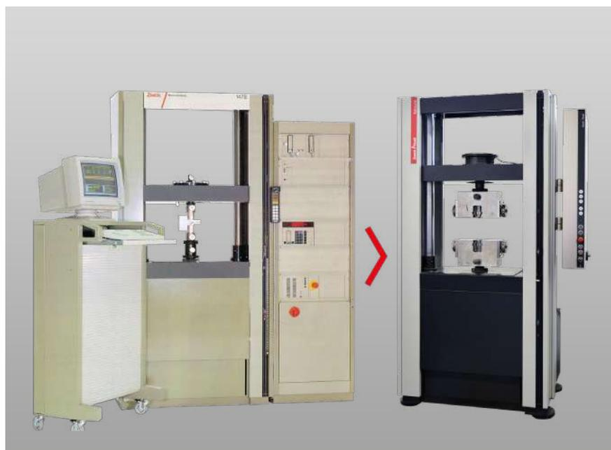
图 1: 配备 testControl II 的静态试验机现代化升级改造
