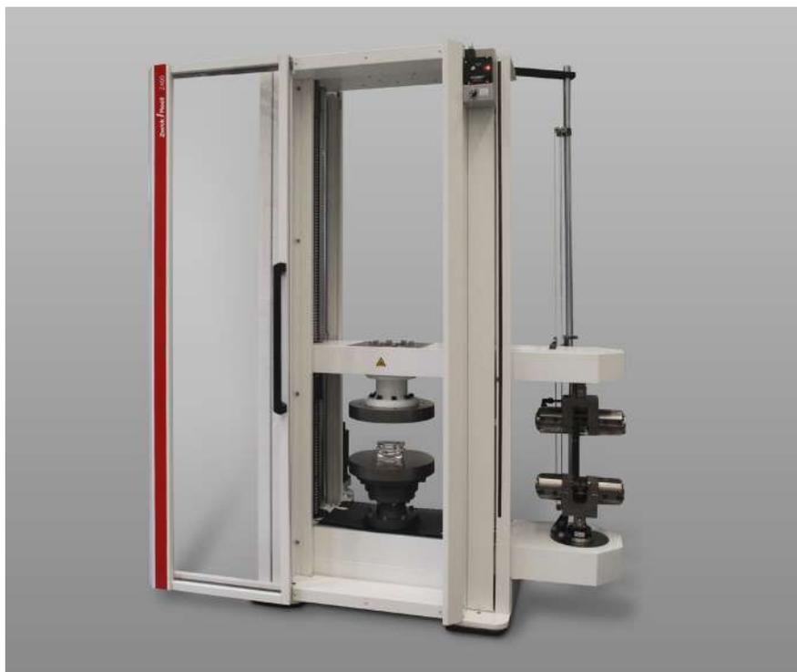
图 1: 配备有两个试验区域的 AllroundLine 材料试验机, 用于对车身部件进行拉伸和压缩试验
