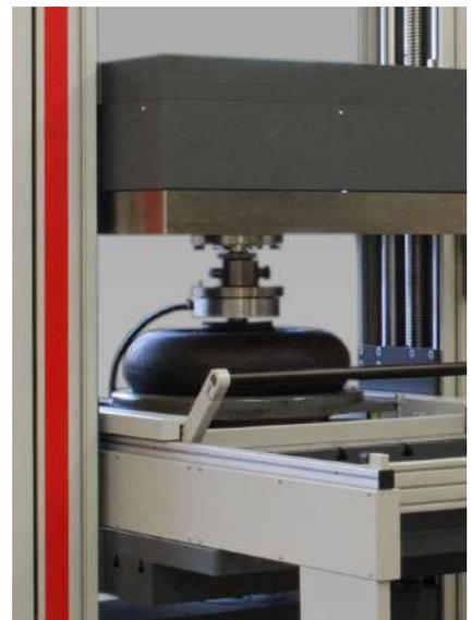
图 2: 空气弹簧试验
