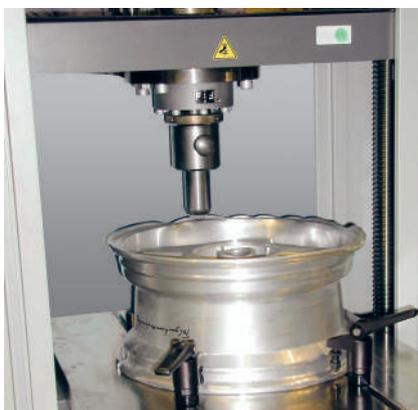
图 3: 轮毂法兰盘轴向变形试验
