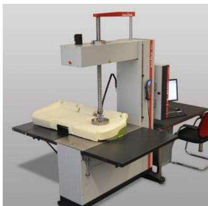
图 1: 测定预成型柔性泡沫的压痕硬度
