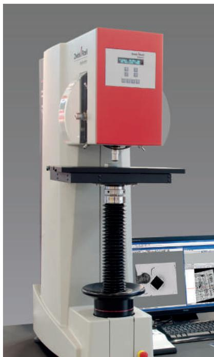
图 2: ZHU250CL 硬度试验机
