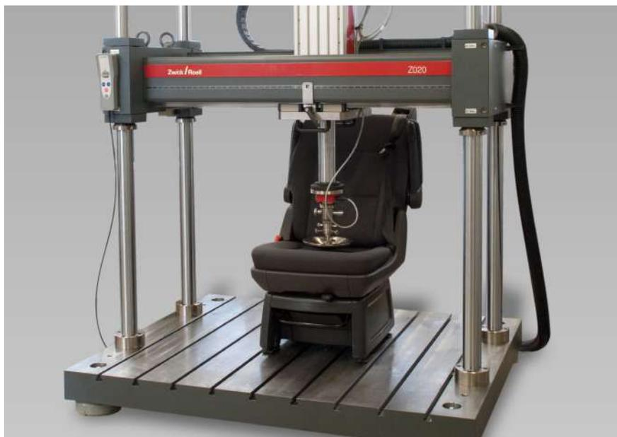
图 2: 用于测试座椅特性的灵活试验台
