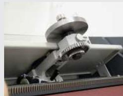
橡胶磨损试验
