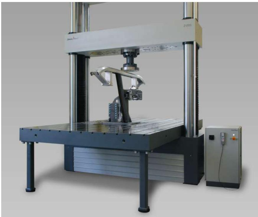
图 2: 用于测试各种车身和结构部件的灵活夹持区域
