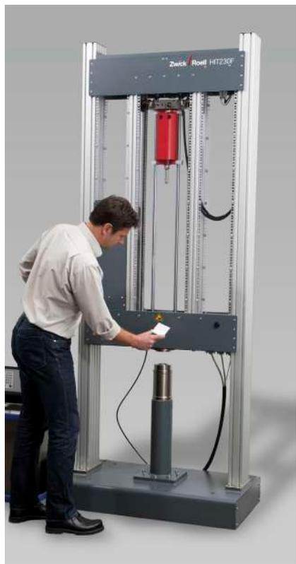
图 2: HIT 230F 落锤冲击试验机
