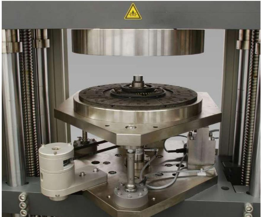
图 1: 测定摩擦离合器的接触力和位移以及推出力和位移
