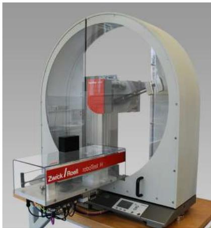
图 1: 配备自动试样上样装置的 HIT50 P 摆锤冲击试验机
