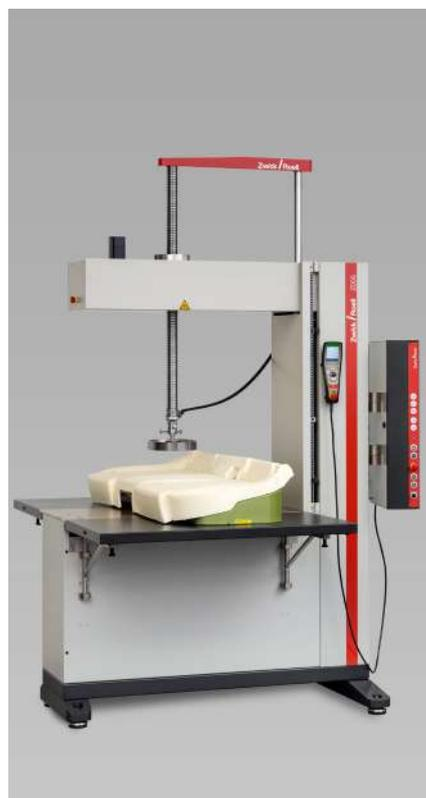
图 4: C 型机架试验机
