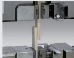
搭接木材拉伸剪切试验
