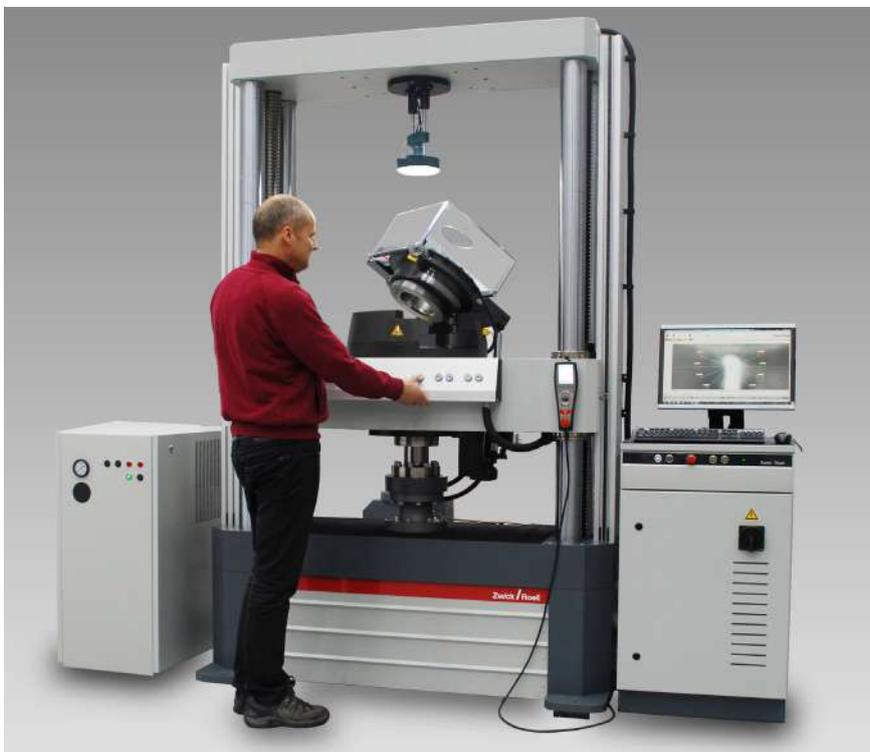
图 1: 配备 videoXtens 的金属薄板试验机
