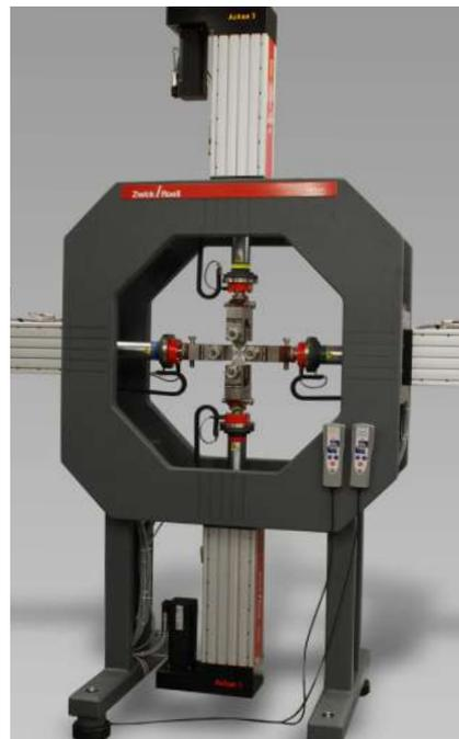
图 4: 30 kN 双轴试验机
