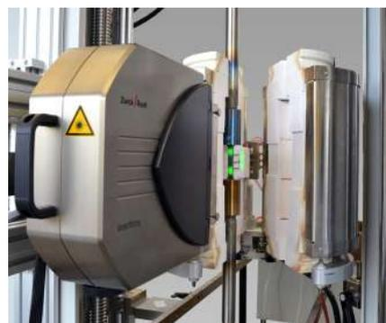
图 4: 加装高温炉
