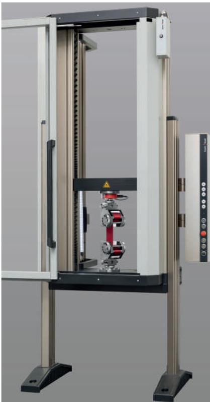
图 1: 安全带拉伸试验
