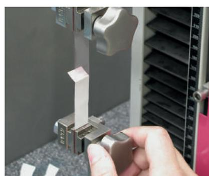
图 7: 胶带剥离试验
