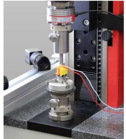
图 3: 安全气囊连接件试验
