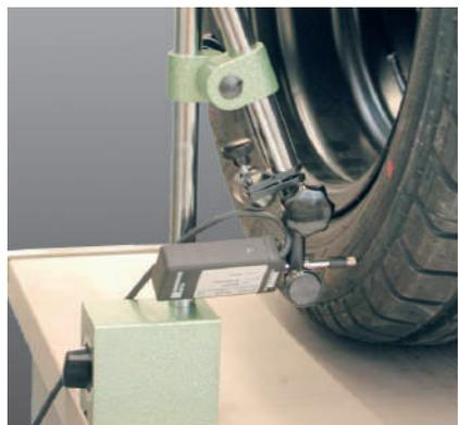
图 2: 通过 testControl 控制轴向力、水平力和胎压
