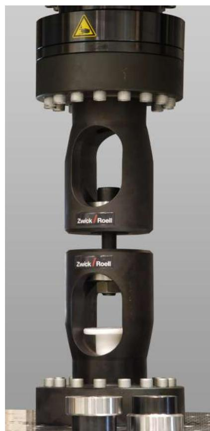
图 2: 使用 Vibrophore 进行螺纹连接件疲劳试验
