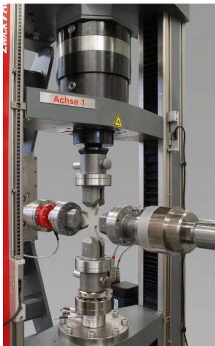
图 2: 叠加扭转双轴试验机
