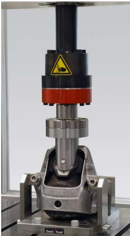
图 1: 发动机安装件单轴疲劳试验
