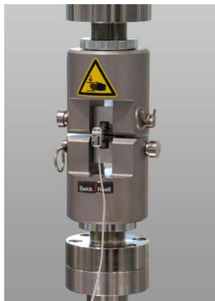
图 2: 测定断裂韧性  $K_{Ic}$
