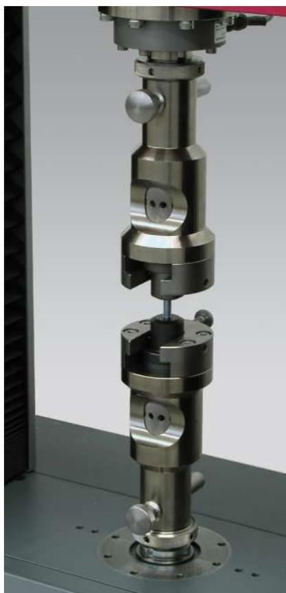
图 1: 螺钉静态拉伸试验
