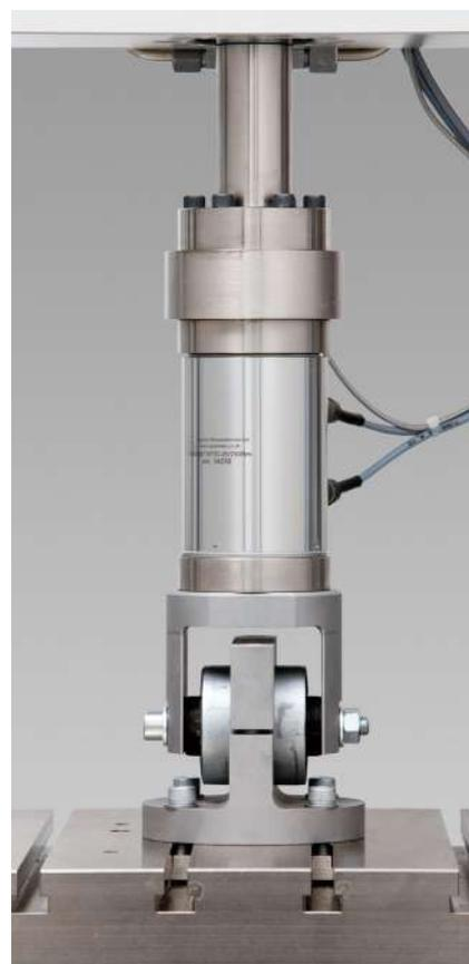
图 3: 橡胶金属减震器试验
