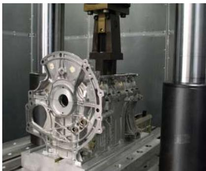
图 1: 发动机缸体疲劳试验
