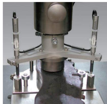
图 5: 刹车盘压缩试验
