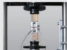
断裂力学试验
