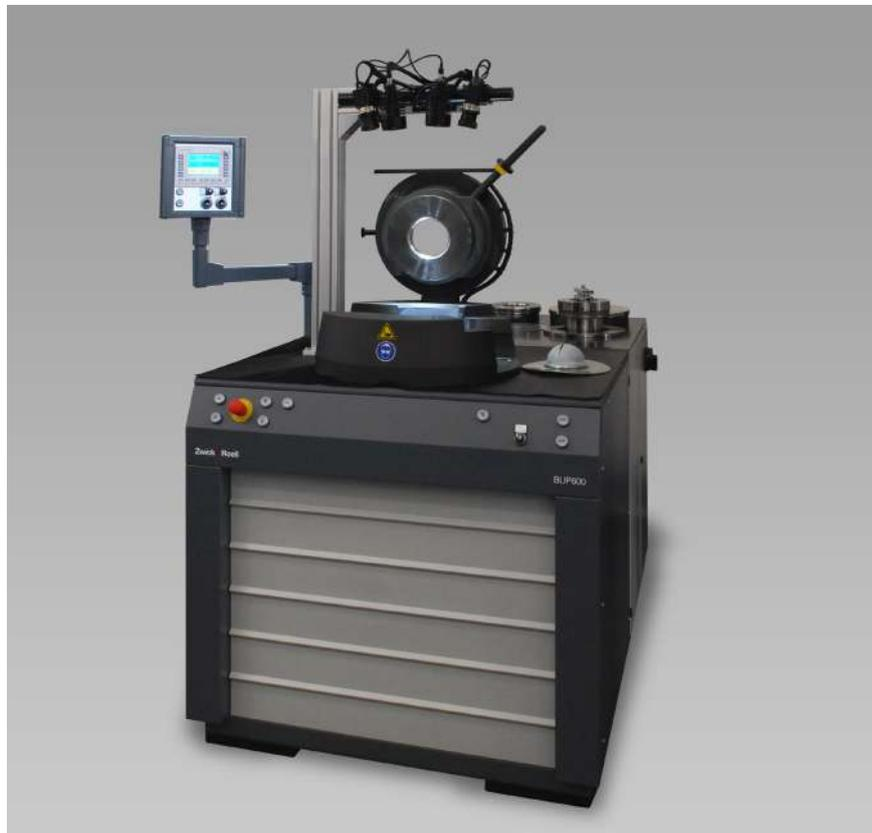
图 1: BUP 600 金属薄板试验机
