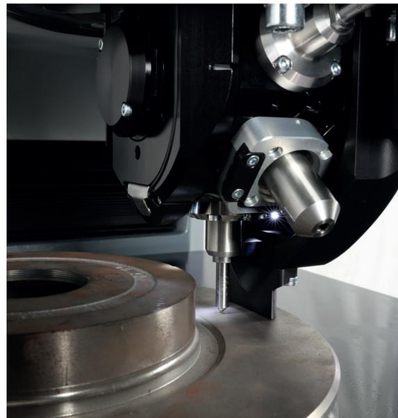
*Prüfung an einer Bremsscheibe mit einseitig demontierten Verspannbacken*
