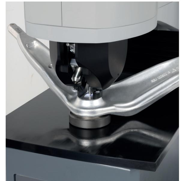
*Prüfung der Härte an einem Querlenker aus dem Bereich Automotive*
