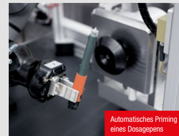
Probenmagazin für Autoinjektor: Abholen Device mit Smart-Roboter
