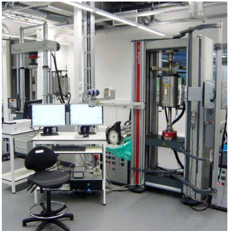
Bild 3: Hochtemperatur-Prüfung (statisch und dynamisch) im Bereich der Umformtechnik (AFRC, Advanced Forming Research Centre, University of Strathclyde)
