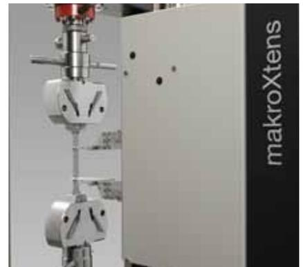
Bild 3: Mechanisch messend, automatisch ansetzend: der makroXtens
