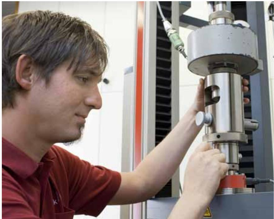
Bild 2: Jeder Kraftaufnehmer erhält eine Zwick-Werkskalibrierung sobald er an einer Prüfmaschine zum Einsatz kommt.
