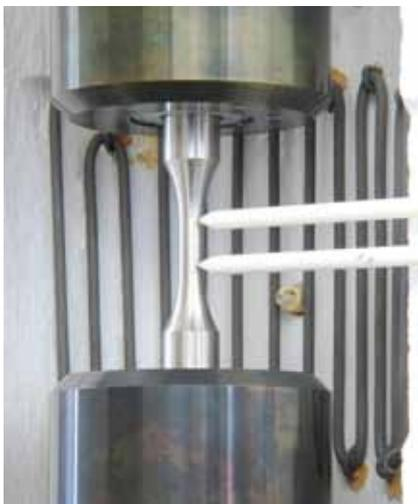
Bild 1: LCF-Versuch unter Hochtemperatur mit angesetztem Dehnungsaufnehmer
