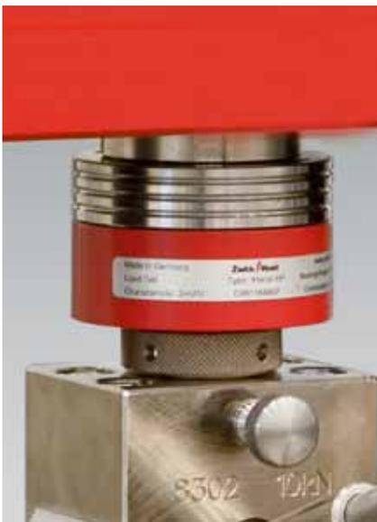
Bild 1: Kraftaufnehmer der Xforce Baureihe mit Mehrfach Biegebalken Mitte
