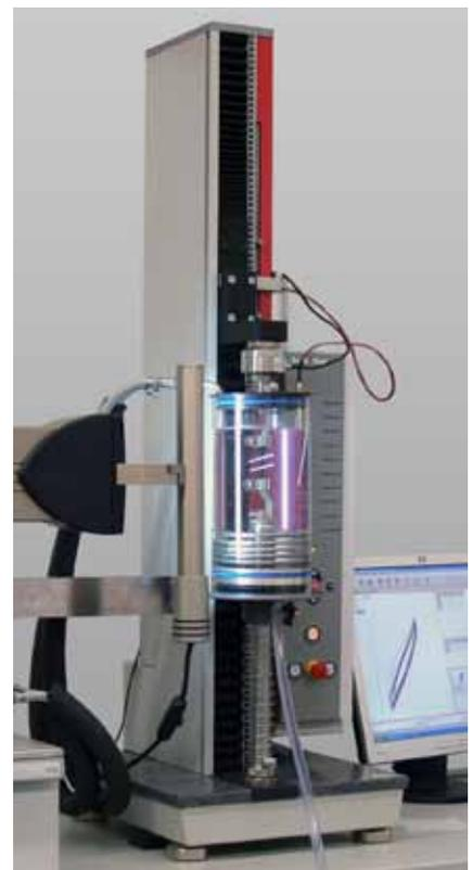
Bild 4: Zugversuch bei 37 °C (+ Mediumbad) mit videoXtens
