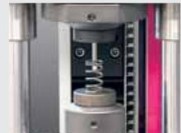
Druckversuch an Präzisionsfedern
