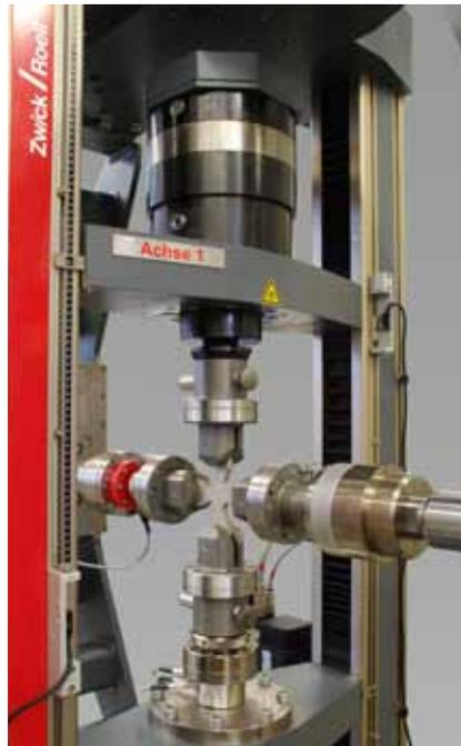
Bild 2: Biaxiale Prüfmaschine mit überlagerter Torsion
