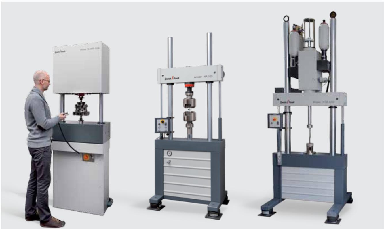
Bild 1: Zwick Hochfrequenzpulsator für hohe Prüffrequenzen bis zu 300 Hz in Resonanz, klassische servohydraulische Prüfmaschine HA 100, Hochgeschwindigkeitsprüfmaschinen HTM 5020 mit 50 kN und 20 m/s
