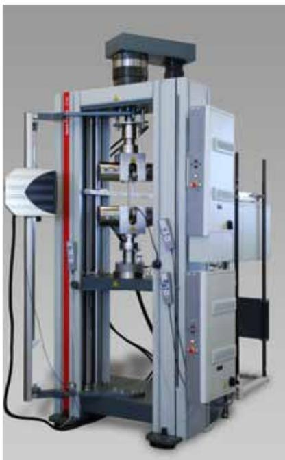
Bild 1: Tension-Torsion Prüfungen mit optischer Dehnungsmessung
