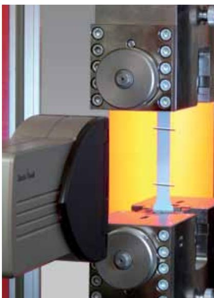
Bild 1: videoXtens mit Probenmarkierung
