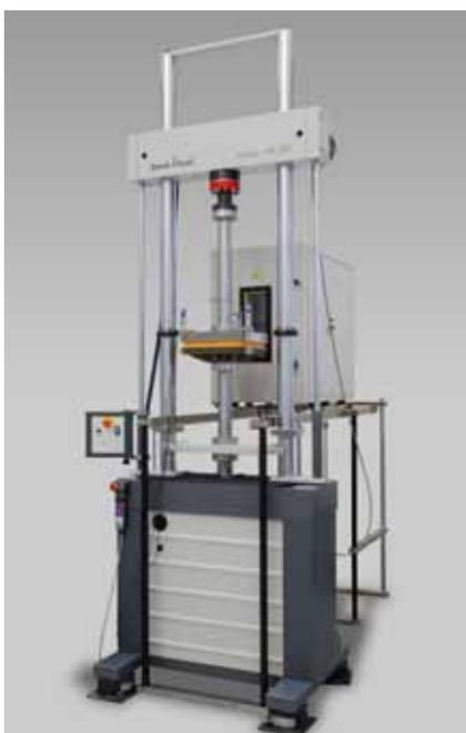
Bild 1: Servohydraulische Prüfmaschine mit Temperierkammer
