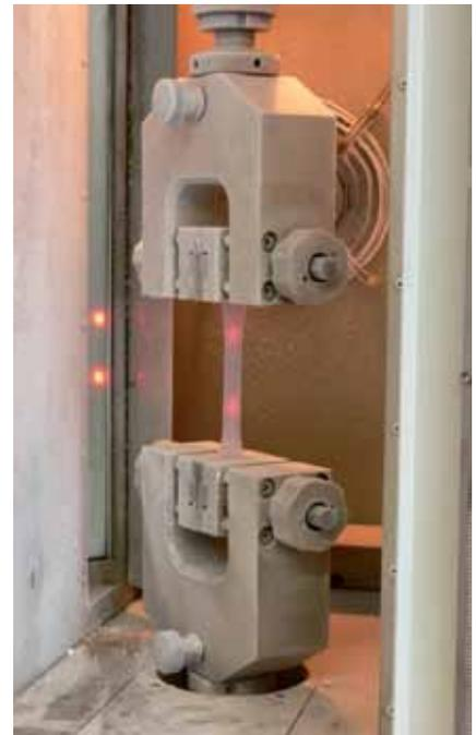
Bild 3: Zugversuch bei - 70 °C mit optischer Dehnungsmessung
