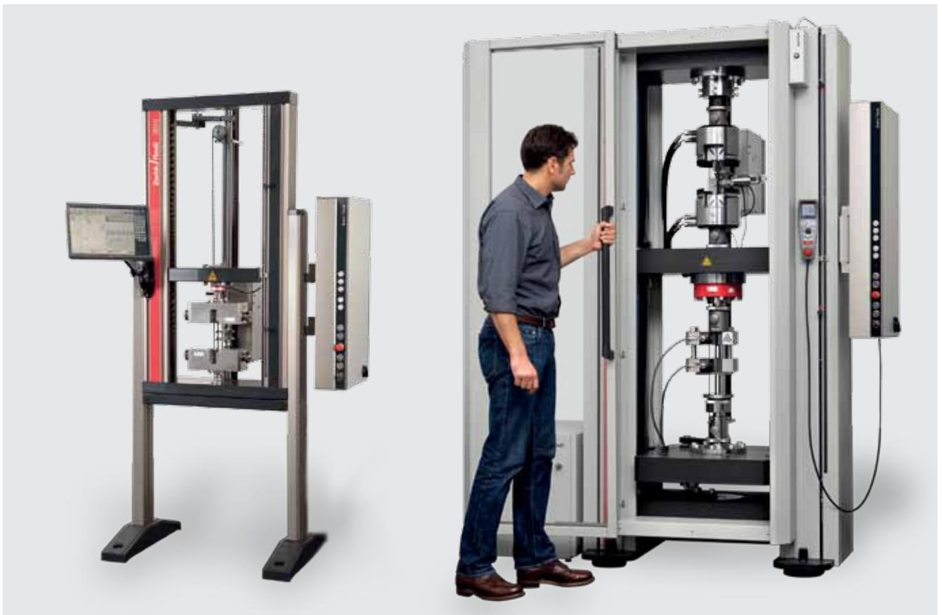
Die AllroundLine ist sowohl als Tischmodell, als auch als Standmodell im Kraftbereich von 5 bis 2.500 kN verfügbar.
