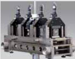
Ermüdungsprüfung an Asphaltproben
