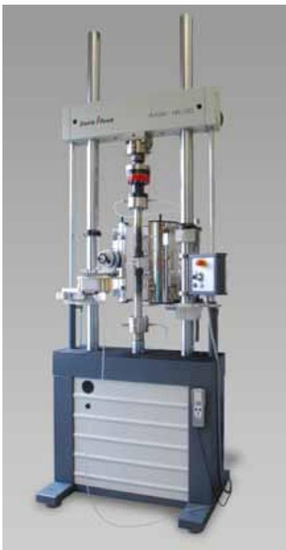
Bild 1: Schwingfestigkeitsprüfung unter Hochtemperatur
