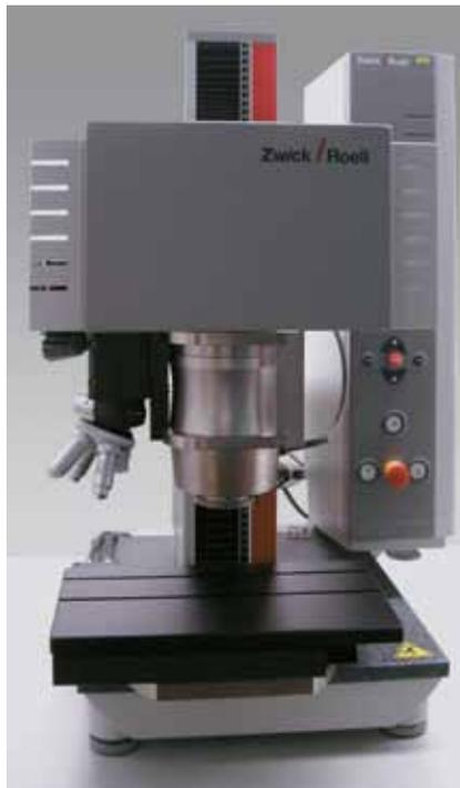
Bild 2: Härteprüfmaschine Zwick ZHU2.5/ Z2.5
