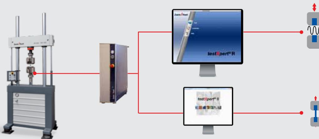
Servohydraulische Prüfmaschine für dynamische und quasi-statische Anwendungen
