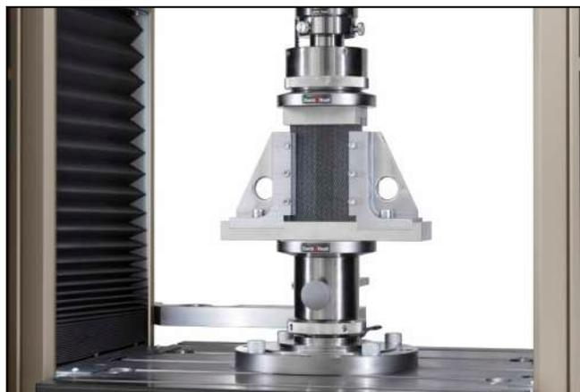
CAI压缩测试夹具, Airbus试验工装
