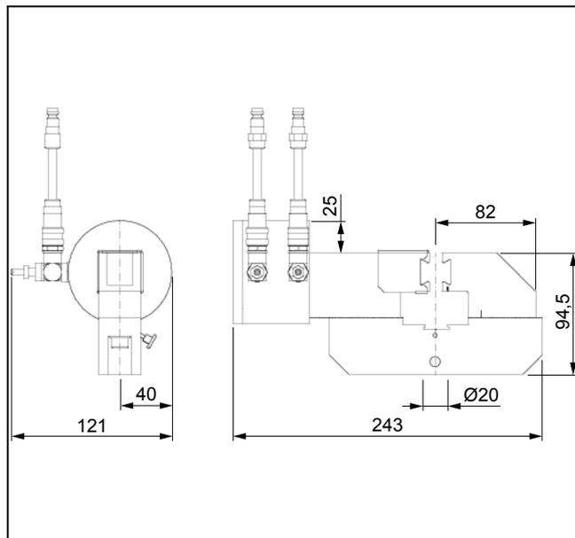
Pneumatik-Probenhalter Typ 8197, Übersicht, Gegenbacke gestuft verstellbar
