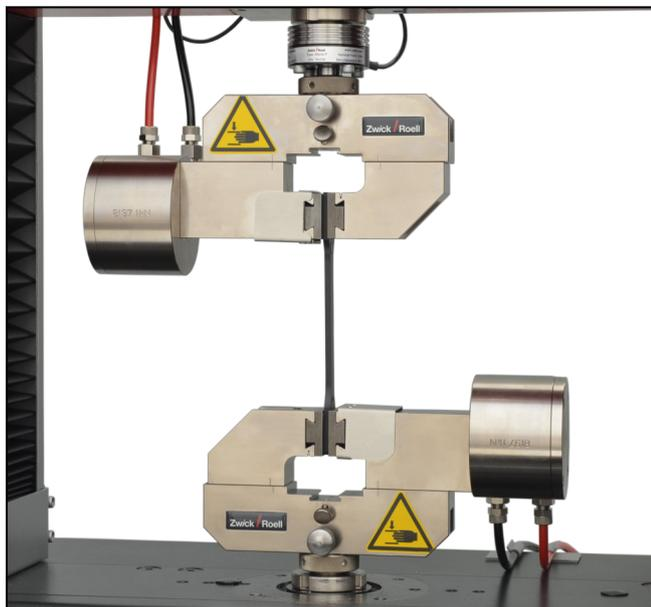
Pneumatik-Probenhalter Typ 8197, Gegenbacke gestuft verstellbar
