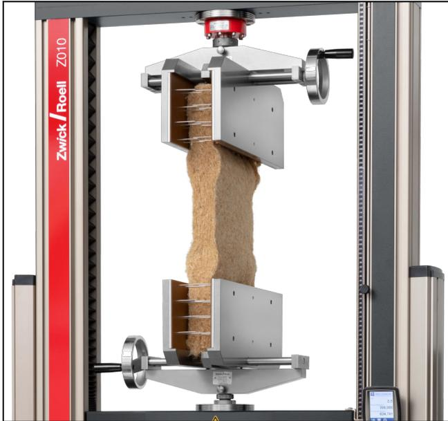
Probenhalter für Dämmstoffe Typ 8330, Fmax 10 kN
