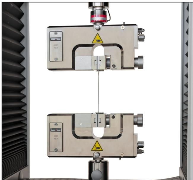
Pneumatik-Probenhalter Typ 8397, Fmax 10 kN
