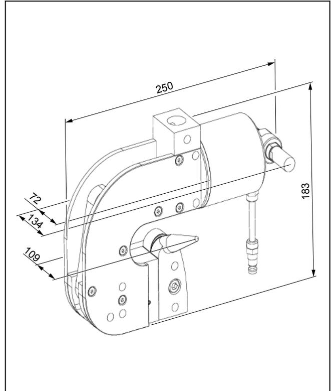
Umlenk-Probenhalter für Reifencorde Typ 8297, Fmax 2,5 kN, Übersicht
