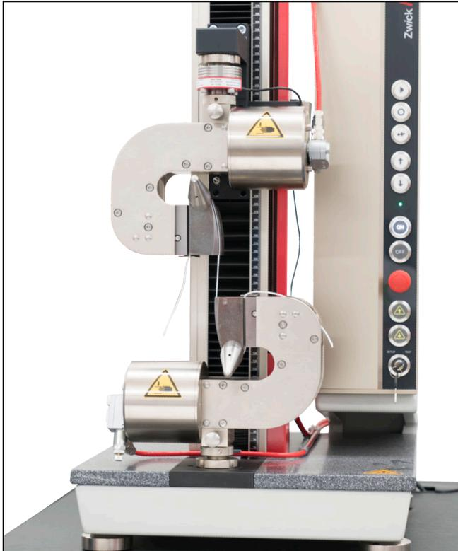
Umlenk-Probenhalter für Reifencorde Typ 8297, Fmax 2,5 kN
