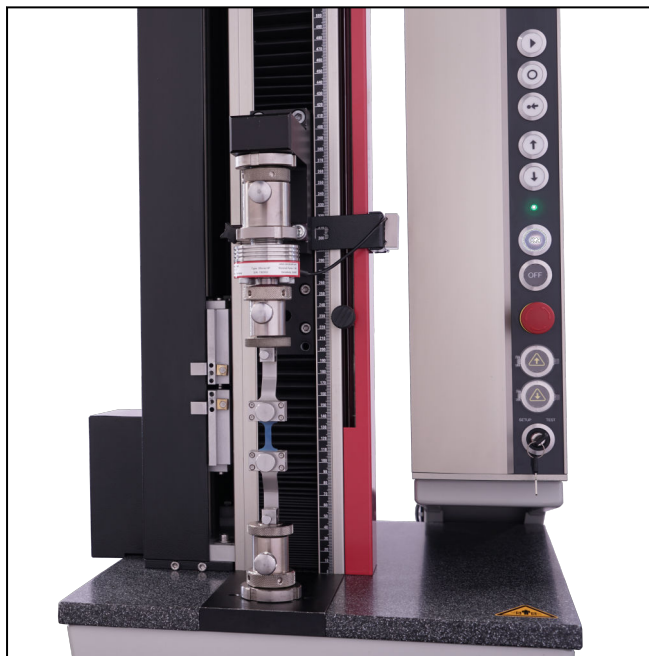
Schraub-Probenhalter Typ 8153, Fmax 20 N
