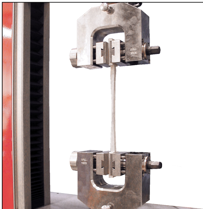
Schraub-Probenhalter Typ 8354, Fmax 10 kN
