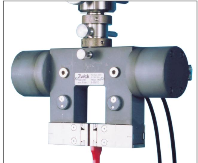
Pneumatik-Probenhalter Typ 8287 Fmax 1 kN, Detail
