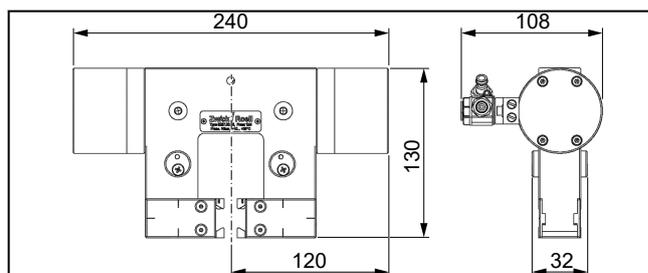
Pneumatik-Probenhalter Typ 8287 F<sub>max</sub> 1 kN, Maße
