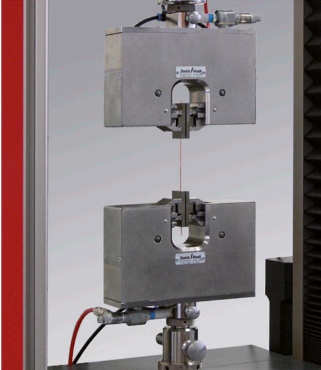
Pneumatik-Probenhalter Typ 8297 mit Backenhöhe 50 mm
