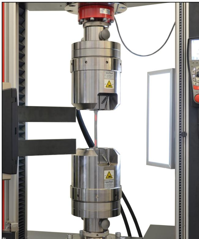
Hydraulik-Probenhalter Typ 8594, Fmax 100 kN, "Körper über Keil"
