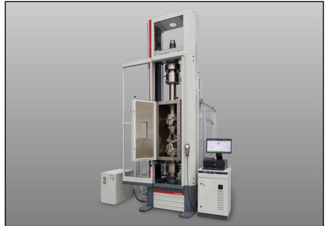
Z600E mit geöffneter Temperierkammer
