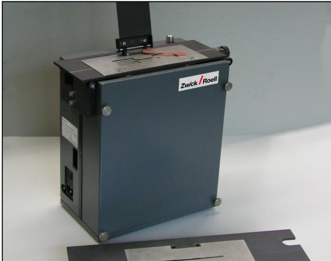
Automatisches Markiergerät, Zusatzschablone zum Markieren von
