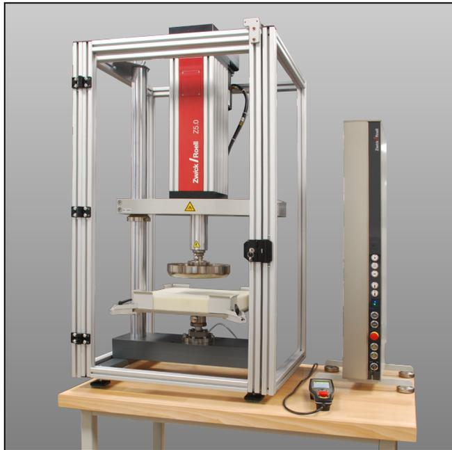
Dauerschwingprüfstand 5 kN
