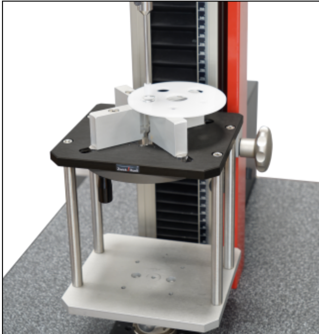
Prüfaufbau mit Universalhalterung, Auflagehalterung und Druckstempel
