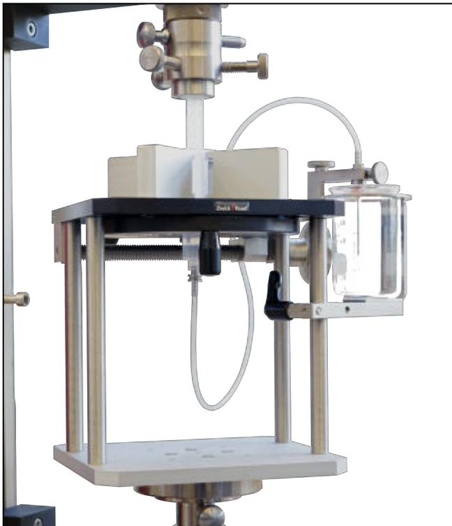
Prüfvorrichtung zur Bestimmung der Kolben-Bewegungskraft –
