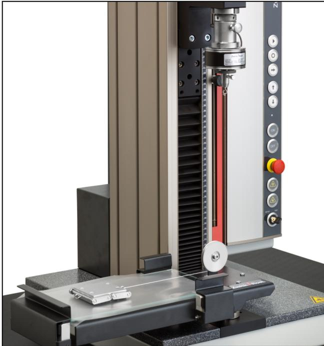
Vorrichtung zur Prüfung des Reibungsverhaltens von Kunststoff-Folien
