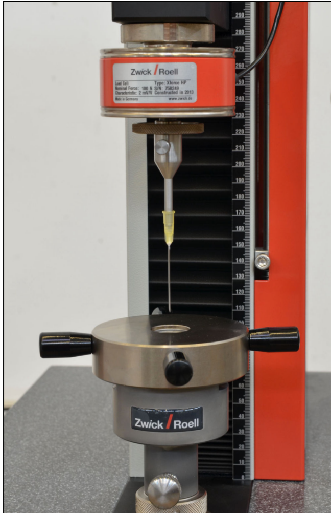
Aufnahme zur Befestigung von Injektionsnadeln mit Luer-Konus
