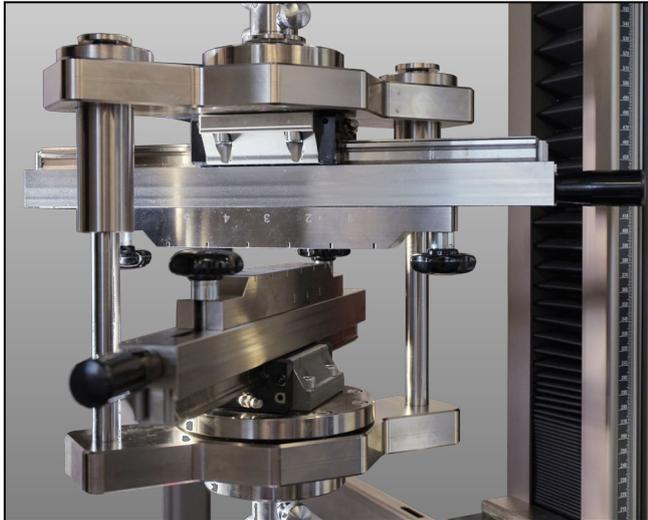
Z-Zugversuch an Papier und Batteriefolien
