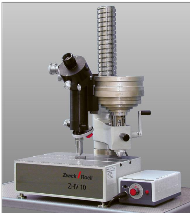
ZwickRoell ZHV10 Härteprüfmaschine nach Vickers, analoge Variante
