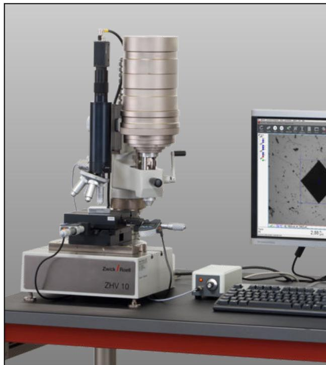
ZwickRoell ZHV10 Härteprüfmaschine nach Vickers, PC-Variante
