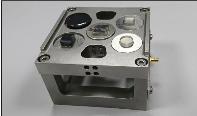
Stahl-Probenhalter für 5 kleine Probeneinsätze Ø 24 mm, isoliertes Oberteil
