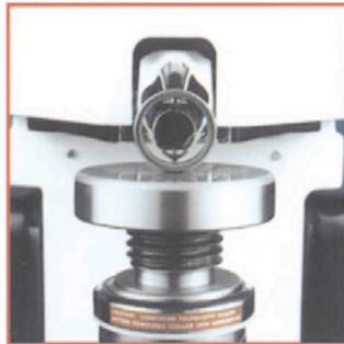
Prüfen eines Lagerrings mit 23mm Durchmesser
