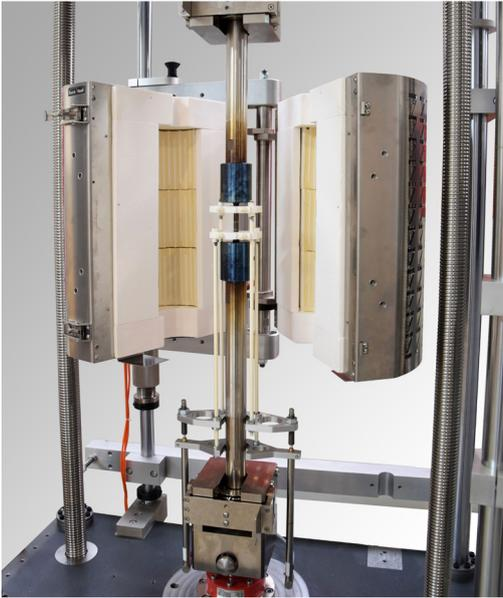
MP-4Rod-Extensometer Keramik (Teile, die der Hitze ausgesetzt sind, sind aus Keramik)
