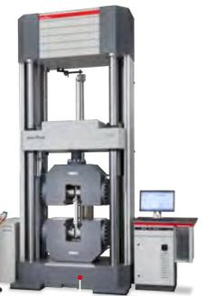
Ensayos de alta capacidad hasta 5.000 kN
