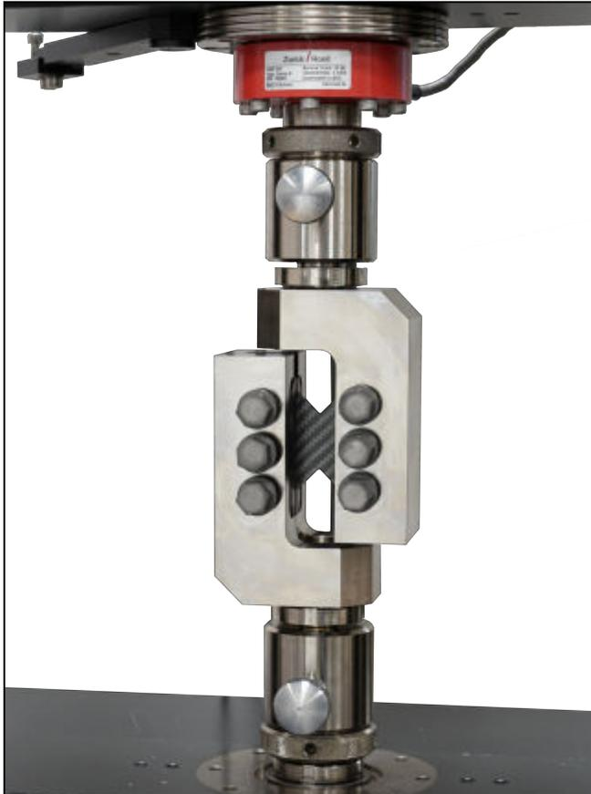
Schervorrichtung nach ASTM D 7078
