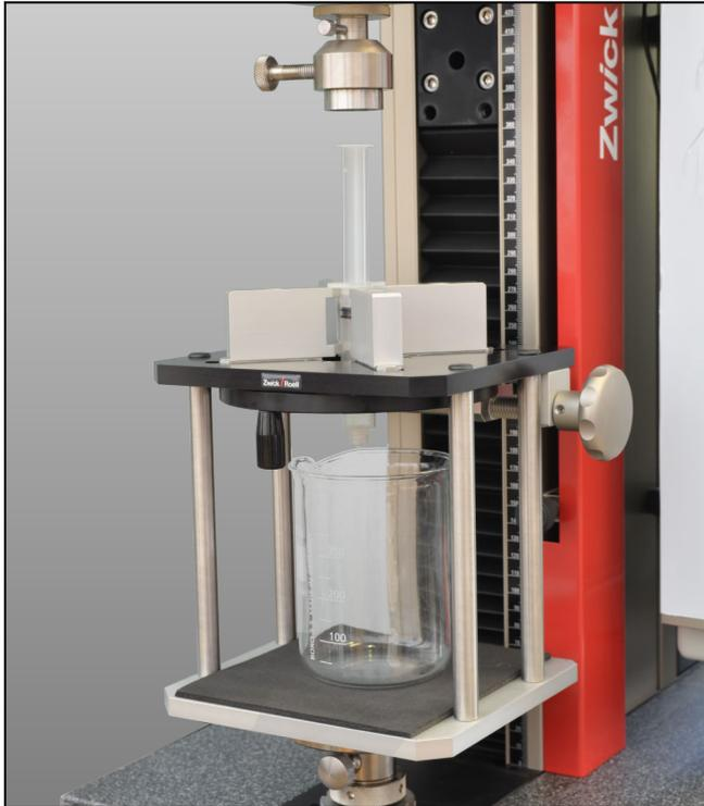
Prüfvorrichtung zur Bestimmung der Losbrech- und Gleitkraft
