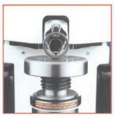
Prüfen eines Lagerrings mit 23mm Durchmesser
